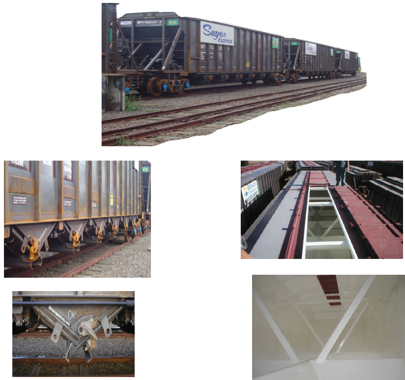
Figura 18 - Vagão de alta performance para transporte de açúcar a granel
