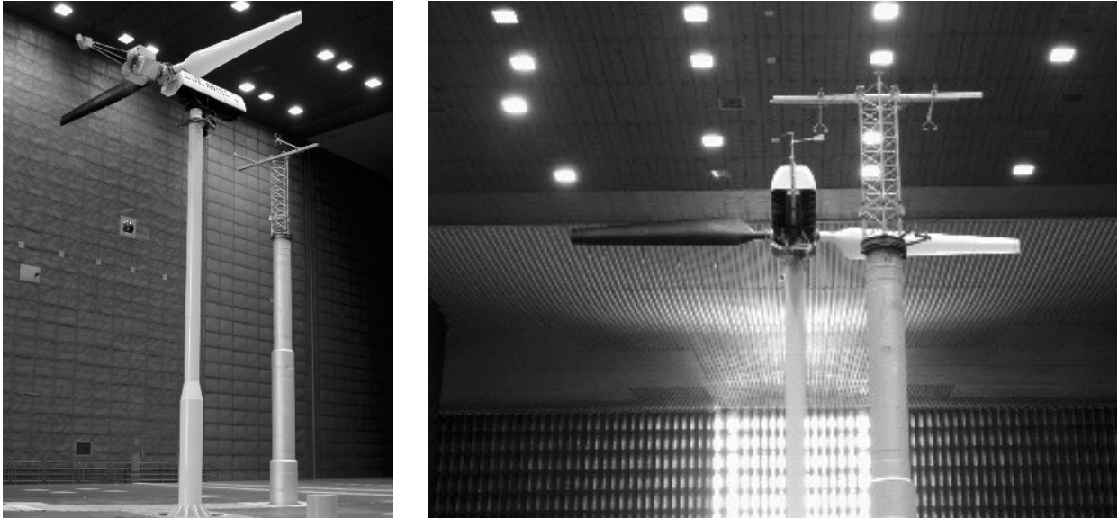
Figura 4.4 -Configuração de medições na esteira próxima (fonte: NREL).
