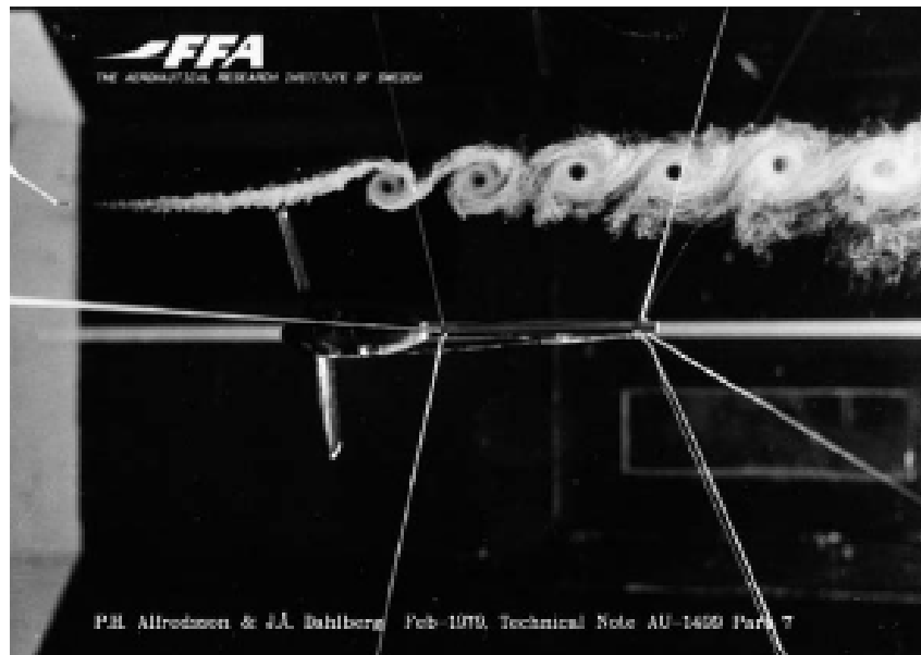
Figura 3.1 – Visualização com Fumaça, revelando os vórtices de ponta de pá [Vermeer et al., 2003]
