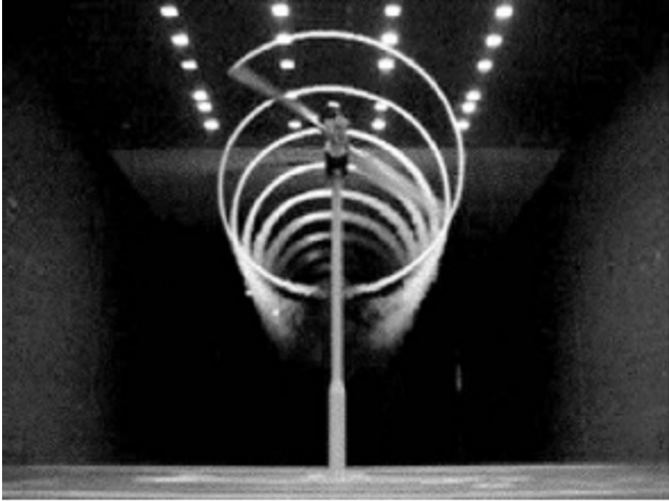
Figura 3.3 – Espiral de vórtices de ponta de pá [Vermeer et al., 2003].
