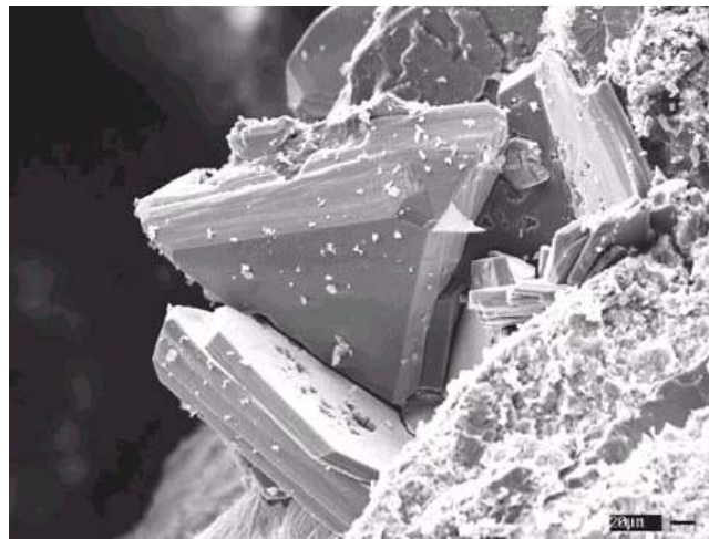
Figura 12. Micrografia Eletrônica de Varredura mostrando a morfologia da fase Portlandita (LIMA, 2004).
