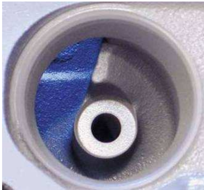
Figura 2.6 – Duto de admissão do cabeçote Vortec com geometria geradora de turbilhonamento
