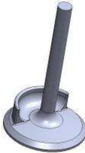
Figura 2.3 – Desenho de válvula com obstrução para geração de Swirl
