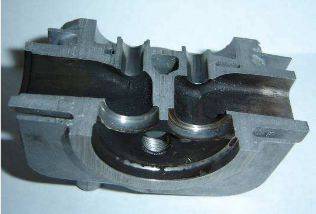
Figura 3.11 – Foto de vista em corte da câmara de combustão e dutos de admissão e escape sem as sedes e guias de válvula
