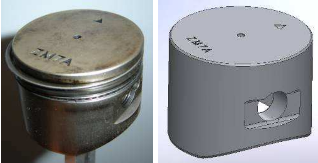
Figura 3.9 – Foto do pistão real e do modelo 3D sem os anéis representados
