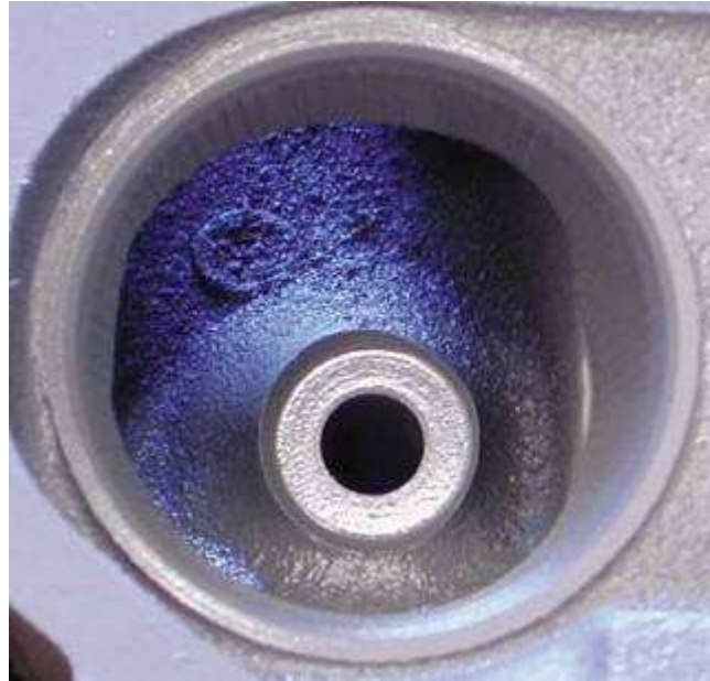
Figura 2.7 – Duto de admissão do cabeçote convencional do motor GM V8 5700 cm 3
