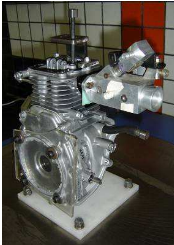
Figura 3.6 – Conjunto completo instalado no banco de fluxo.
