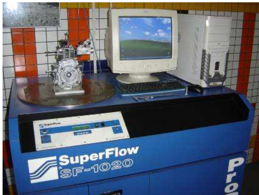
Figura 3.4 – Banco de Fluxo, instalação do motor para teste.
