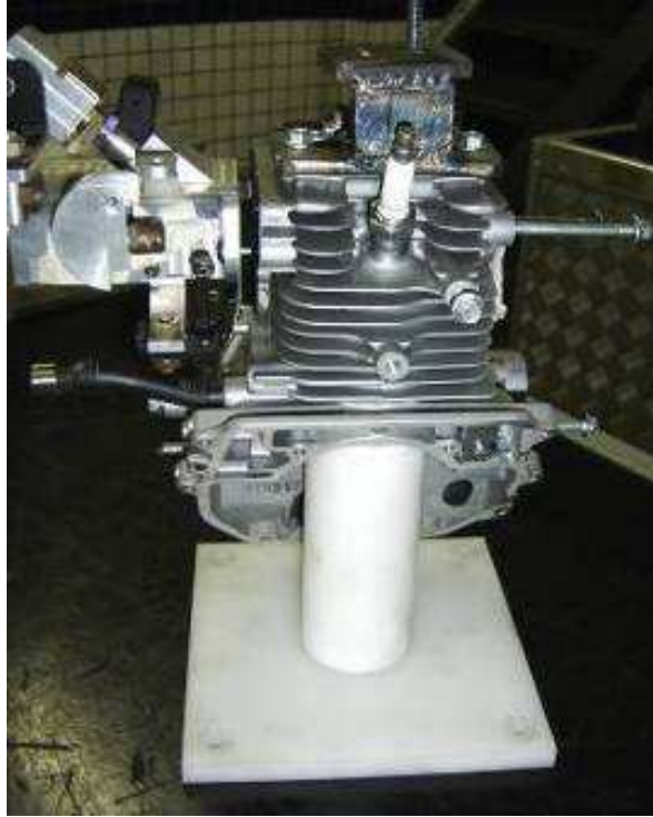
Figura 3.5 – Duto e placa de adaptação para instalação no banco de fluxo.
