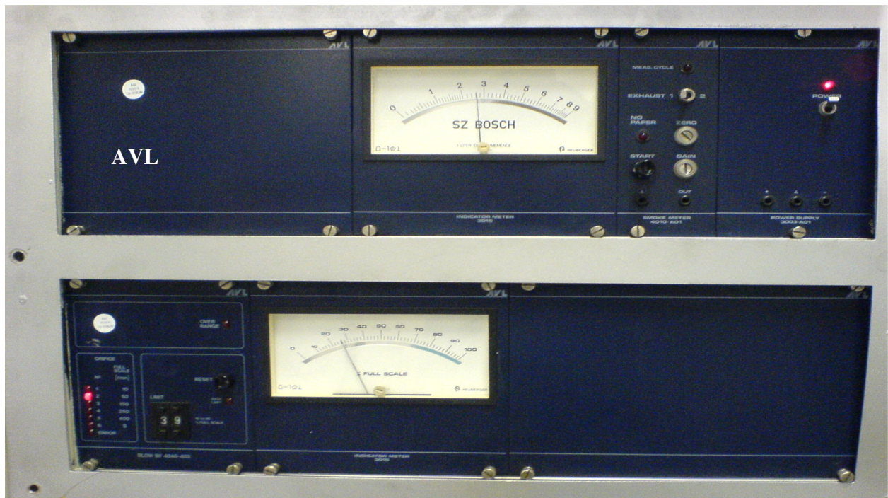
Figura 4.11 – Equipamento AVL (medidor do índice de fumaça). Adaptado de Agrale (2008).
