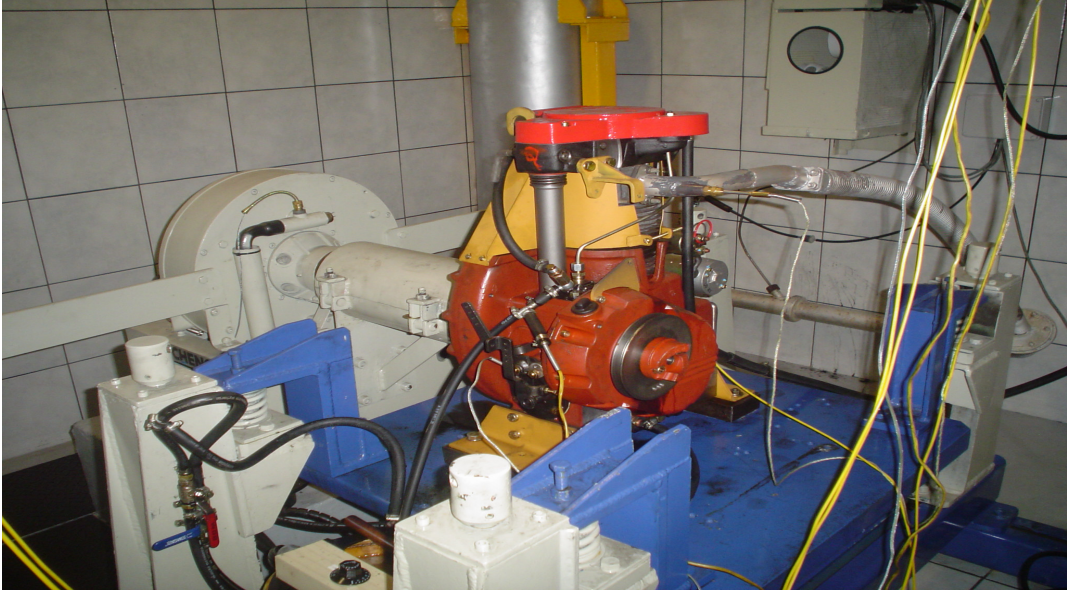
Figura 4.5 – Dinamômetro Schenck e motor acoplado. Adaptado de Agrale (2008).
