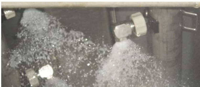
Figura 3.15- Esguichos marca Spraying Systems montados em um túnel de pasteurização (Fonte: Ziemann-Liess)
