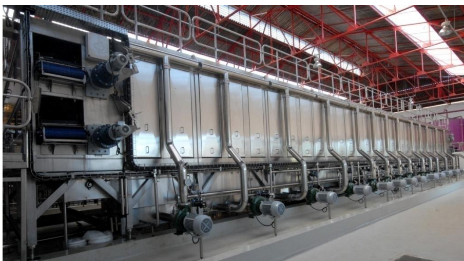
Figura 2.2 – Túnel de pasteurização para cerveja (fabricante Ziemann-Liess)
