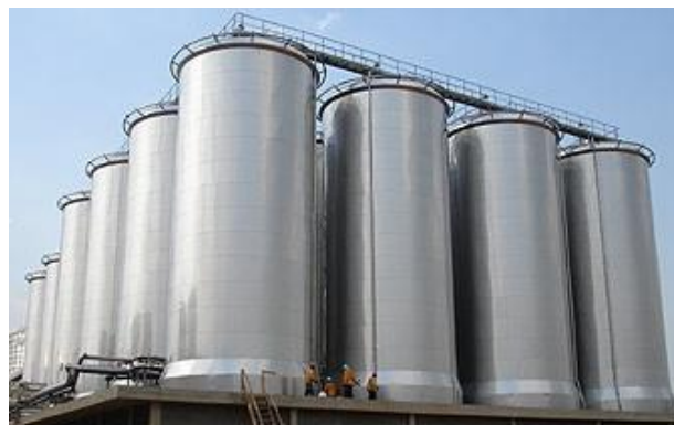
Figura 1.2 - Tanques de fermentação e maturação da cerveja (Fonte: www.zl.ind.br )
