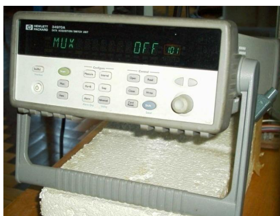
Figura 3.7 – Aquisidor de sinal instalado na bancada
