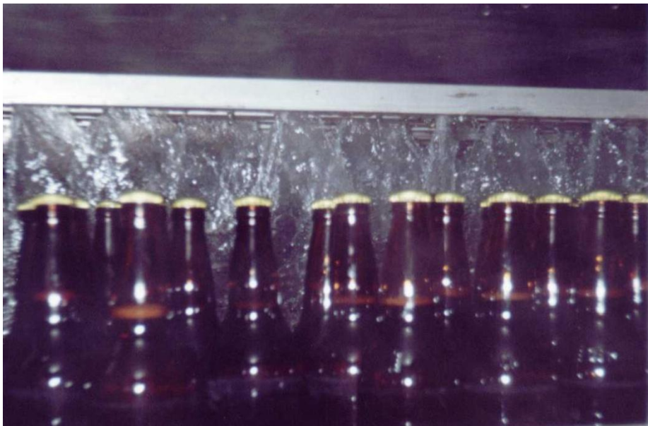
Figura 3.12 - Tubo quadrado com recorte em “U” esguichando em um túnel de pasteurização (Fonte: Ziemann-Liess)
