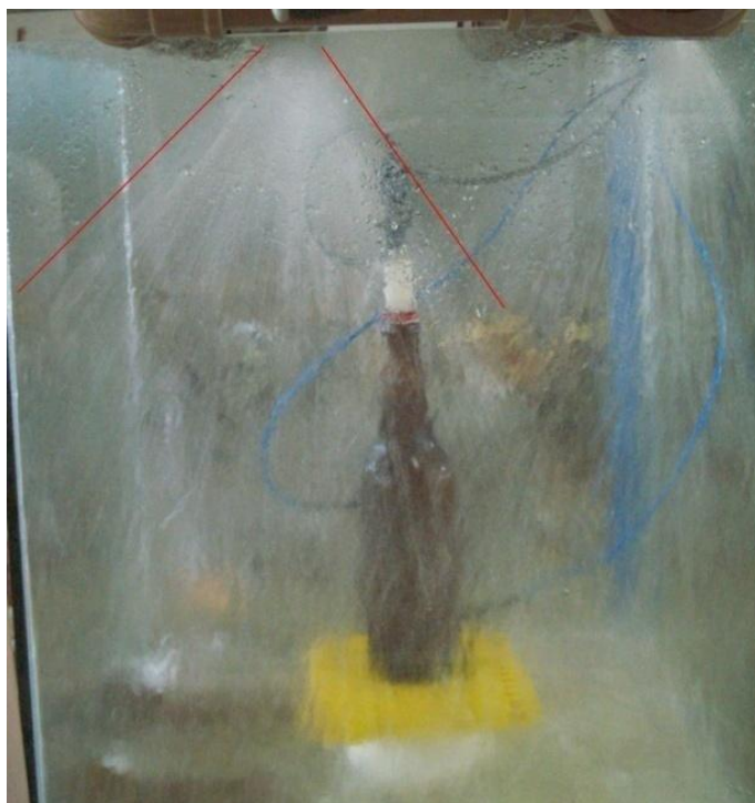
Figura 4.4 – Esguichos marca Spraying Systems instalados na bancada e a indicação do cone com um ângulo de 90° produzido pelo aspersor
