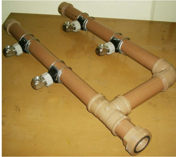
Figura 3.13 - Tubo com os esguichos marca Spraying Systems utilizado na bancada
