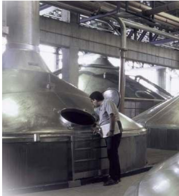
Figura 1.1 - Tina para o cozimento do malte (Fonte: www.cervesia.com.br )
