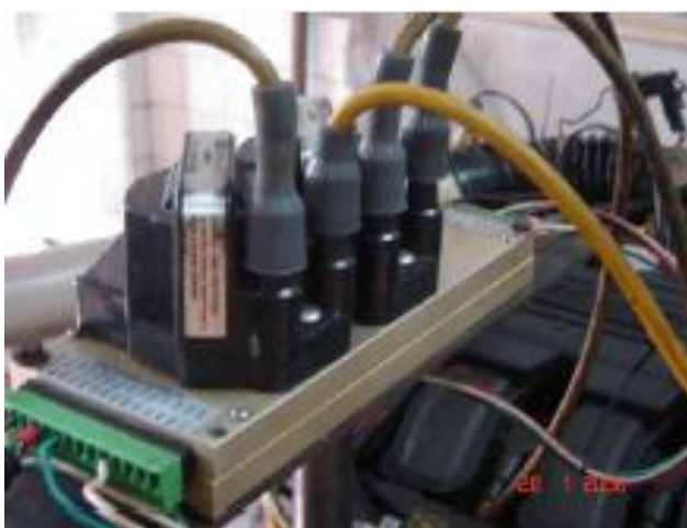
Figura 4.3 - Detalhe da TEC-II formada pelos sistemas de injeção e ignição.
