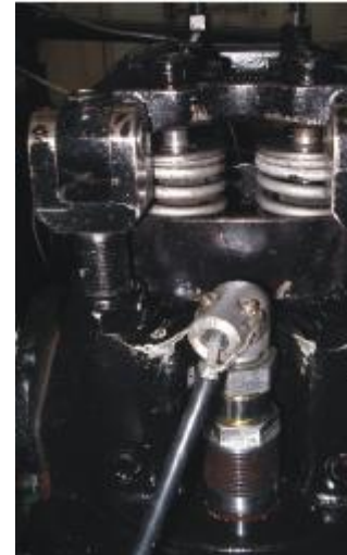
Figura 4.2 - Sensor de detonação modelo D-1, fabricado pela Waukesha Motor Co.
