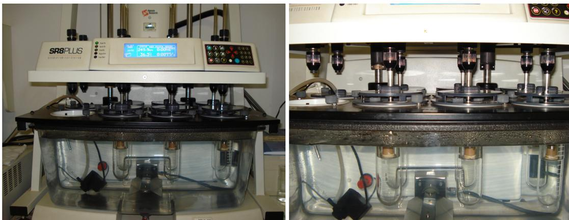
**Figura 3.1:** Fotografias do aparelho Dissolutor SR8PLUS – Hanson Virtual Instruments.
