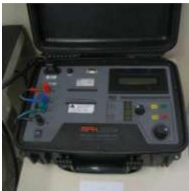
Figura 3.8 – Multiohmímetro (ponte de kelvin) MEGABRÁS modelo MPK-2000.
