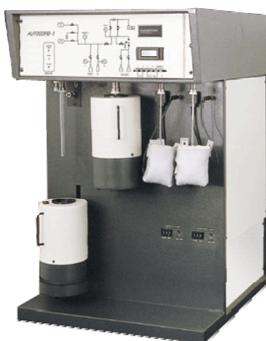
Figura 16. Equipamento utilizado para as análises de fisissorção de nitrogênio do laboratório de materiais da UFPel.
