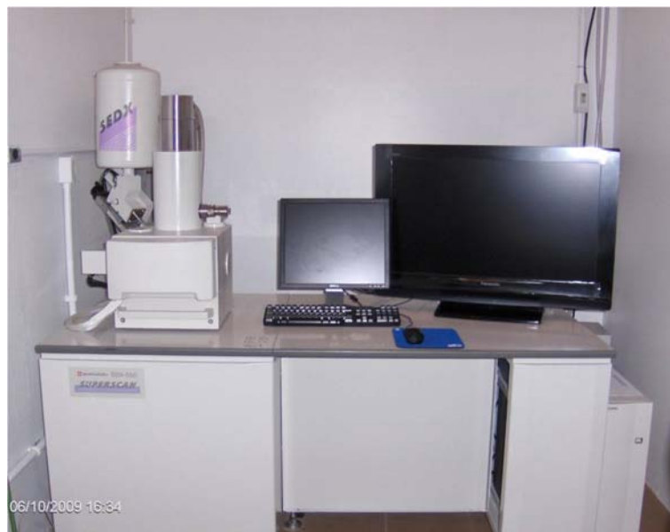
Figura 17. Microscópio eletrônico de varredura do centro de microscopia da UFPel.
