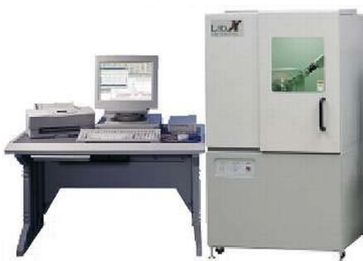
Figura 15. Difratômetro de raios X do laboratório de materiais da UFPel.
