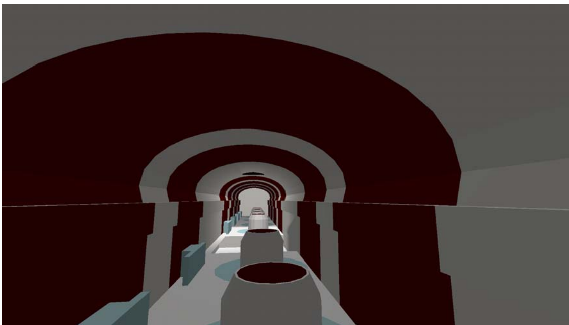
Figura 6.38 – Modelo do Piso do Gerador da PA IV com enclausuramento parcial com revestimento de material acústico na superfície interna e material absorvedor parcialmente aplicado às paredes laterais e teto.
