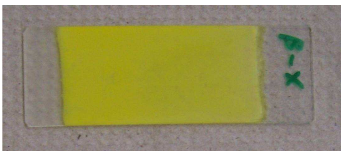
Figura 4.9 – Filme fino de Sulfeto de Cádmio depositado no substrato de vidro
