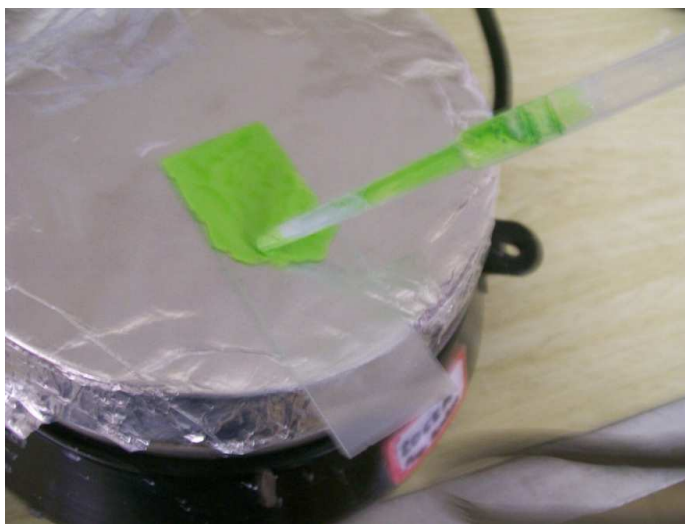
Figura 4.8 – \text{TiO}_2 com corante sendo depositado sobre o vidro
