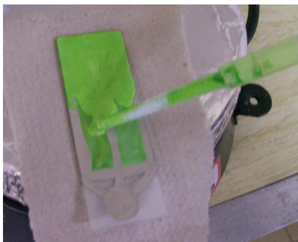
Figura 4.12– Segunda camada de \text{TiO}_2 sendo depositada
