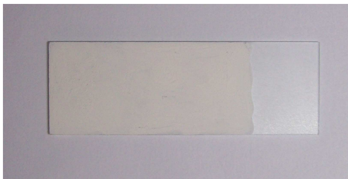
Figura 4.6 – Filme fino de \text{TiO}_2 depositado no substrato
