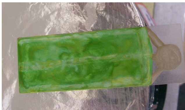
Figura 4.13 – Filme de \text{TiO}_2 com o condutor elétrico entre duas camadas
