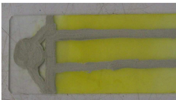
Figura 4.10 – Filme de CdS com o contato elétrico
