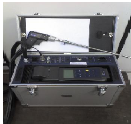
Figura 3.8: Medidores de concentração: a) Tempest-100; b) Greenline.
