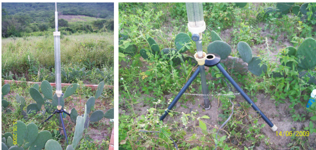
Figura 13. Teste de condutividade hidráulica realizado com o permeâmetro de Guelph, em parcela de erosão com plantio de feijão e palma em nível.
