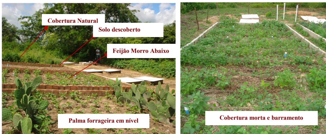
Figura 12. Detalhe das parcelas experimentais de erosão instaladas nas bacias experimentais (Santos et al., 2009c).
