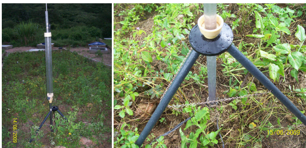
Figura 14. Teste de condutividade hidráulica realizado com o permeâmetro de Guelph, em parcela de erosão com barramento de pedra e cobertura morta.
