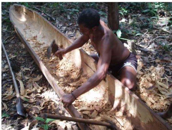
Figura 26: Construção de um casco com a madeira Itaúba (*Mezilaurus itauba*), para transporte de quilombolas.
