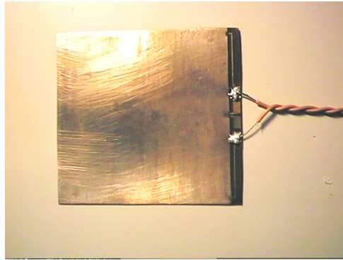
Figura 4.13. Transdutor de fluxo de calor a gradiente tangencial.
