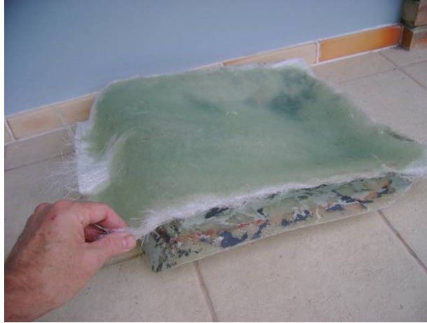
Figura 4.5. Moldagem da estrutura da base do manequim
