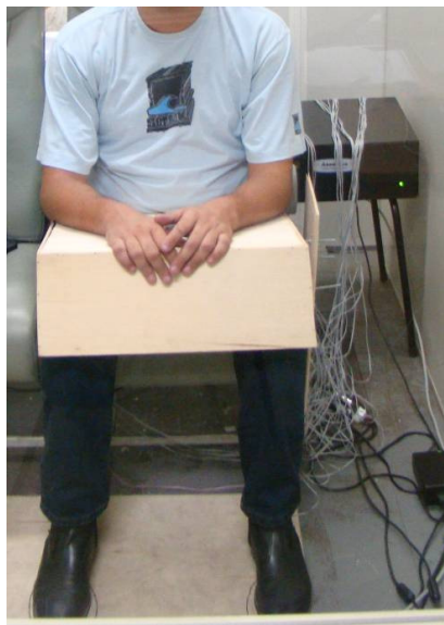
Figura 5.9. Envelope de madeira para controlar posicionamento do passageiro no banco.
