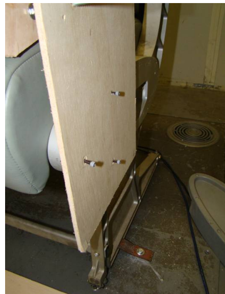
Figura 5.9. Envelope de madeira para controlar posicionamento do passageiro no banco.
