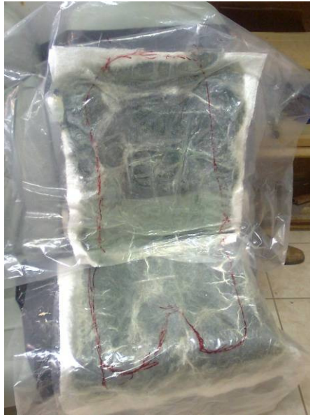
Figura 4.3. Demarcação da área de contato no assento e no encosto (base e tronco)
