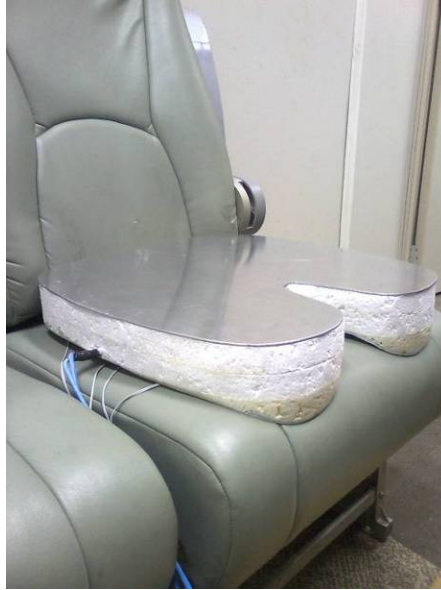
Figura 4.9. Detalhe da chapa de alumínio sobre o isolamento térmico do base (assento) do manequim térmico
