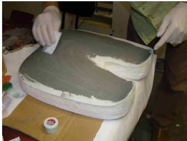
Figura 5.11. Aplicação de resina plástica para ajuste da forma da base do manequim.
