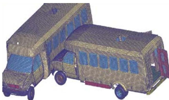
Figura 3 – Simulação de impacto entre dois veículos (KWASNIEWSKI et al., 2006).
