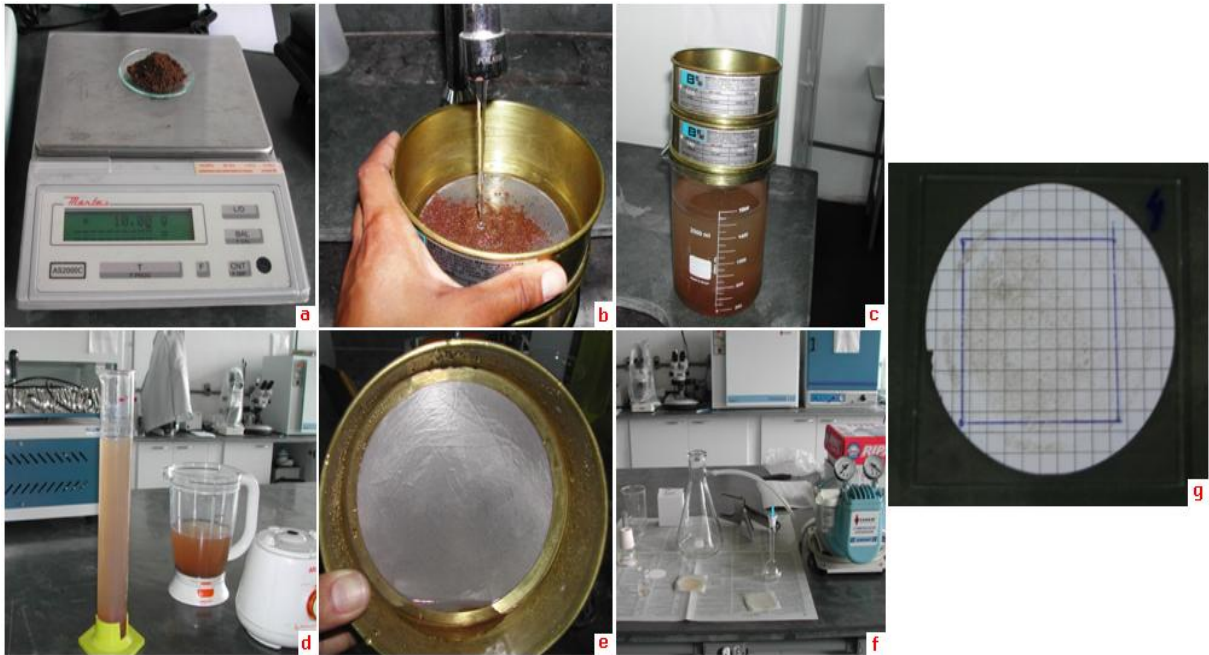
Figura 4.10: Etapas da metodologia utilizada para a análise de quantificação do comprimento de micélio total de fungos micorrízicos arbusculares. a) Pesagem da amostra de solo; b) Peneiramento do solo; c) Solução preparada; d) Agitamento e decantação da solução; e) Coleta da alíquota para contagem; f) Preparação da lâmina de contagem; g) Lâmina de contagem.
