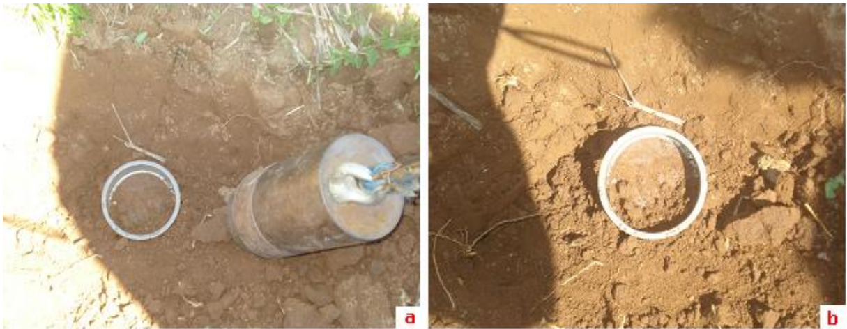
Figura 4.7: Etapas da metodologia utilizada para a análise da densidade do solo. a) Penetração do anel no solo; b) Retirada do anel de Uhland.
