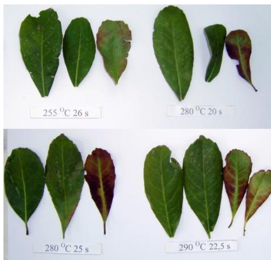
Figura 4.1 Folhas de erva-mate queimadas no tratamento térmico para inativação das enzimas PFO e POD
