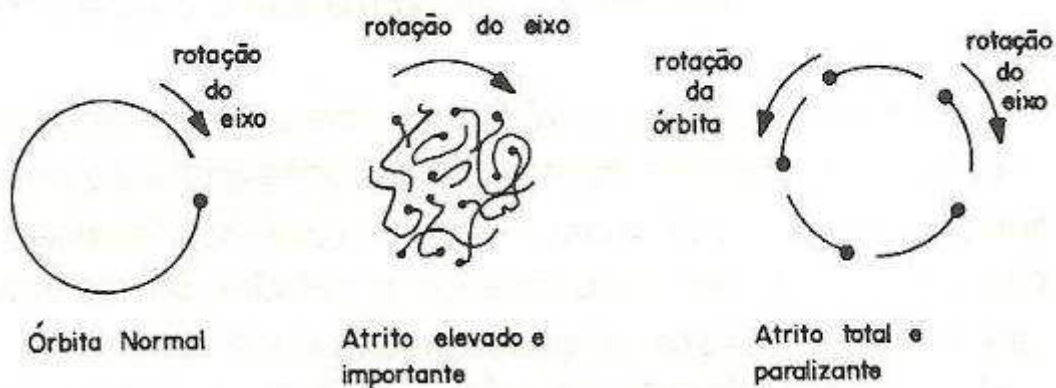
Figura 2.9 - Órbitas obtidas através do osciloscópio. (Nepomuceno, 1989)
