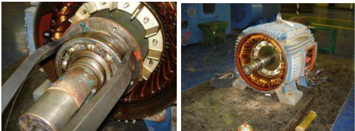
Figura 4.8 - Etapas do processo de desmontagem do Motor N°2
