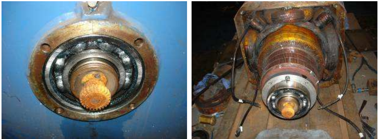
Figura 4.7 - Etapas do processo de desmontagem do Motor N°1
