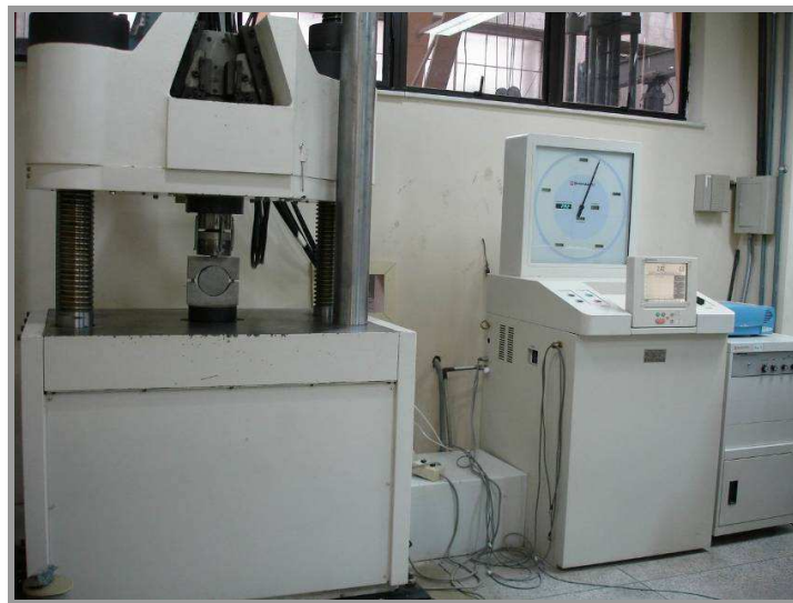
Figura 61 – Prensa de ensaios Shimadzu UH-F com ensaio de tração por compressão diametral.
