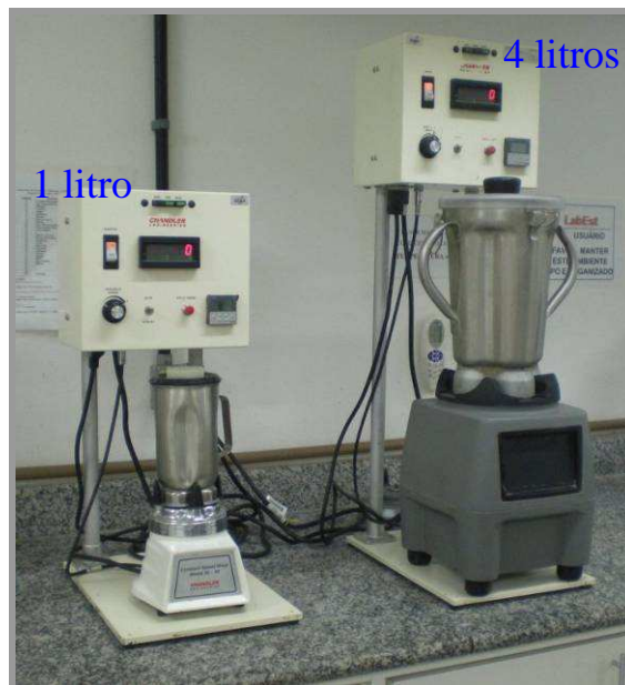
Figura 36 – Misturadores de palhetas Chandler: capacidade de 1 litro (à esquerda) e capacidade de 4 litros (à direita).
