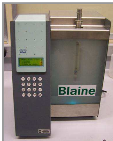
Figura 43 – Equipamentos Blaine automático BSA1 .
