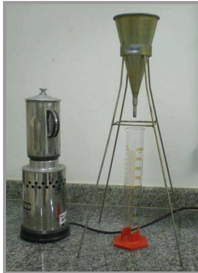
Figura 46 – Misturador (à esquerda) e Funil de Marsh com proveta graduada (à direita).
