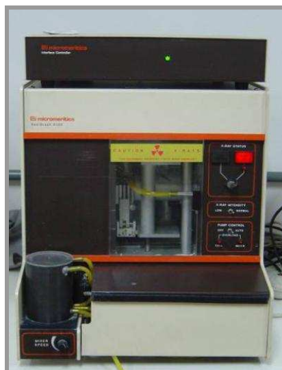
Figura 41 – Equipamento Sedigraph 5100 (VELASCO, 2008).
