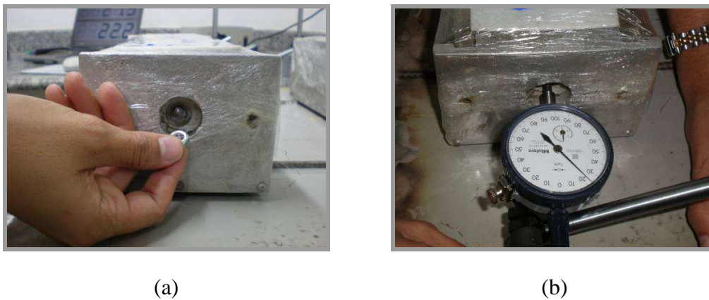
Figura 83 – Preparo dos moldes para colocação dos relógios: (a) Retirada do parafuso; (b) Posicionamento do relógio comparador.
