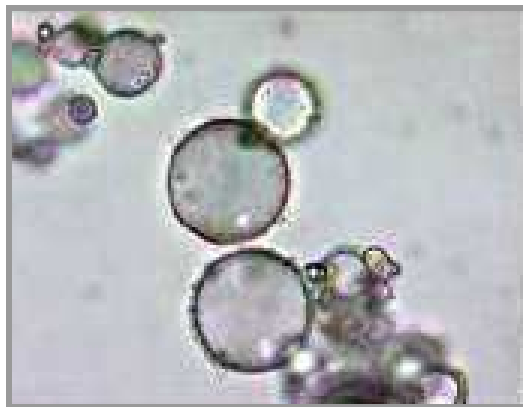
Figura 4 – Microscopia óptica de uma microesfera oca de vidro (MIRANDA, 2008).
