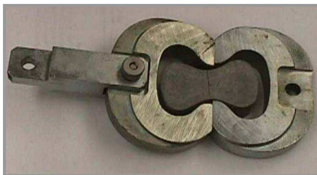
Figura 14 – Geometria do corpo-de-prova de tração direta (HEINOLD et al. , 2002).
