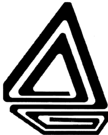
Figura 2.34 – Exemplo de uma bobina usinada de uma fina chapa condutora e de alta resistência mecânica (Kamal, 2005).
