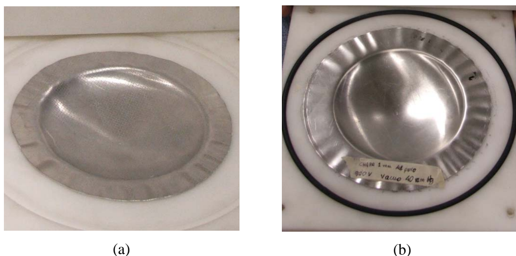
Figura 5.10 – Resultados da estampagem eletromagnética de chapa com espessura s=1\text{mm} : (a) pressão atmosférica (b) 400mmHg.
