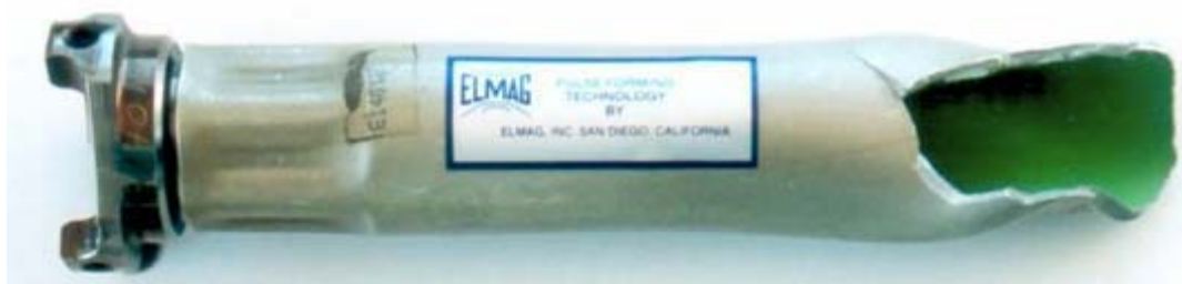
Figura 2.31 – Eixo usado no Boeing 777 mostrando o comportamento quando submetido a um teste de torque até a falha. A falha acontece fora da região de encaixe (Kamal, 2005).
