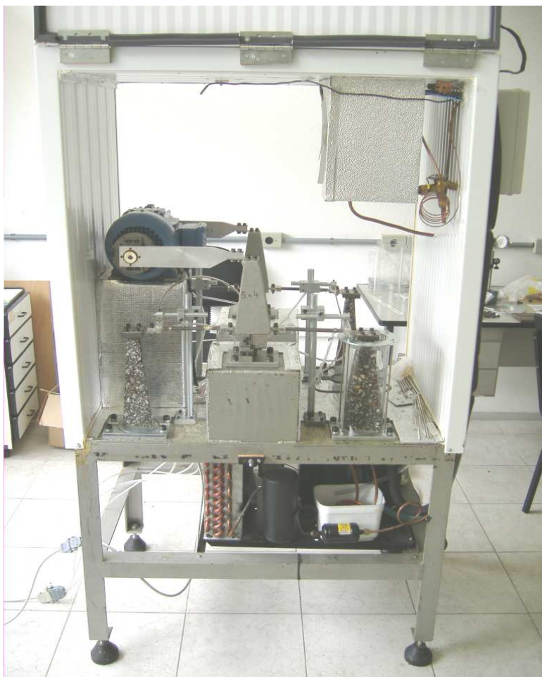
Figura 8.22 - Máquina para execução dos ensaios de módulo complexo e de fadiga (primeiro protótipo projetado e desenvolvido no Brasil, Laboratório de Pavimentação da UFSC).
