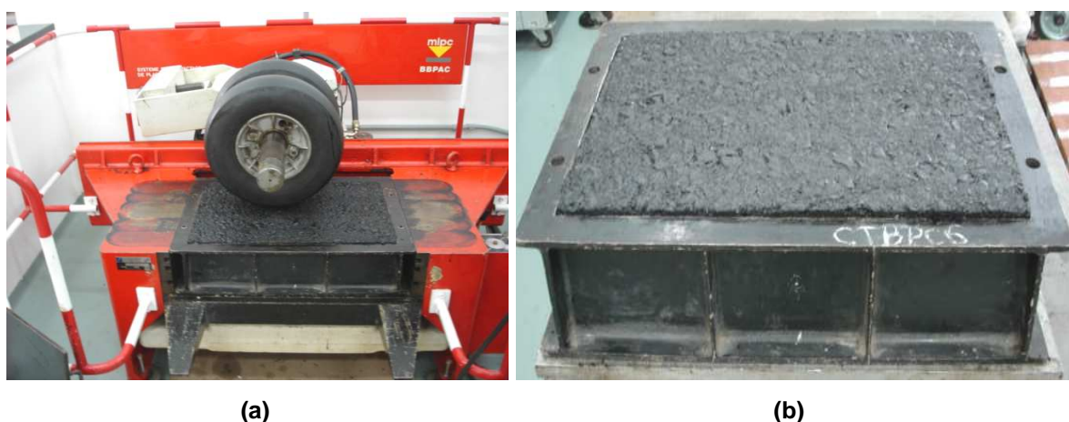
Figura 8.15 - Placas de misturas asfálticas (a) durante e, (b) após o processo de compactação.
