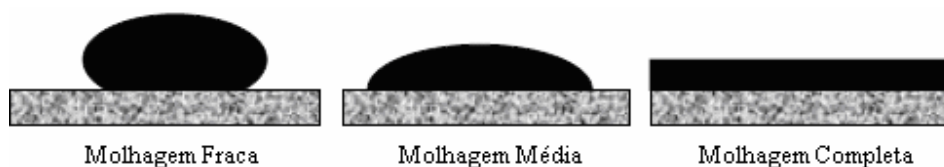
Figura 6.3 - Estágios de molhagem de um sólido por um líquido (CASTAÑEDA, 2004).
