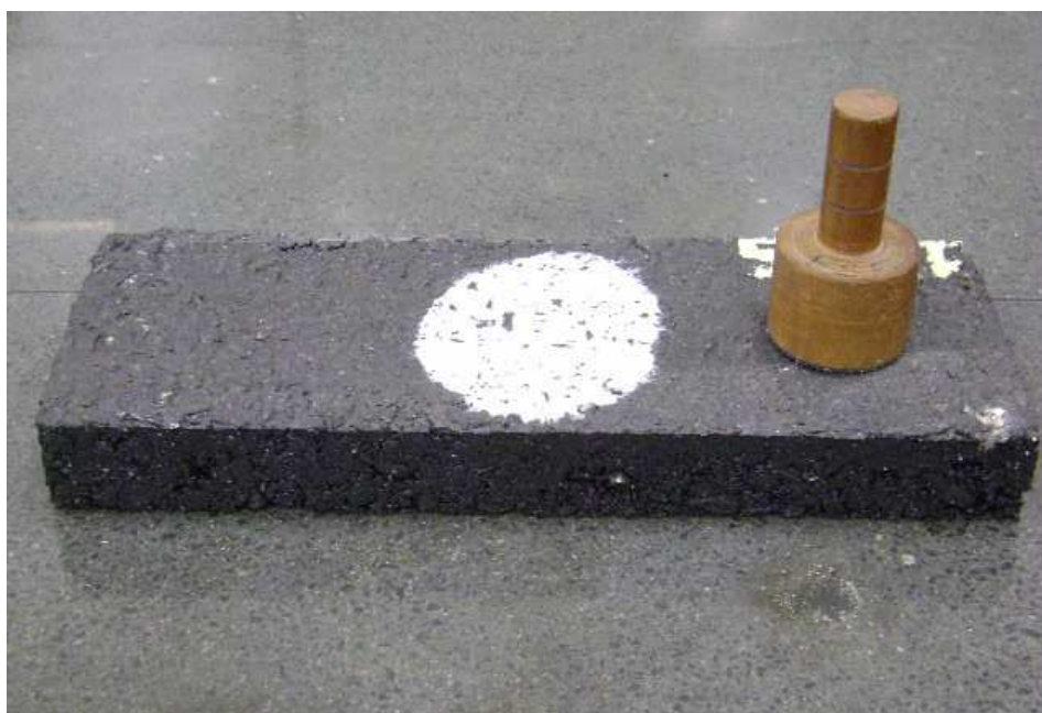
Figura 8.31 - Medição da macrotextura sobre a superfície de uma placa de mistura asfáltica com o ensaio da mancha de areia.
