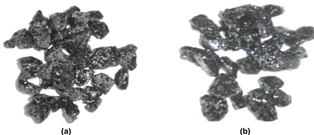
Figura 7.8 - Aspecto da adesividade dos sistemas granular-betume e granular-mástique: (a) com o ligante betuminoso em estado puro e após a adição de 6% de pó de brita, e (b) após a adição de 6% de pó calcário.
