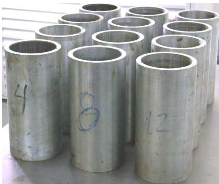
Figura 8.5 - Moldes de aço para compactação das misturas asfálticas.
