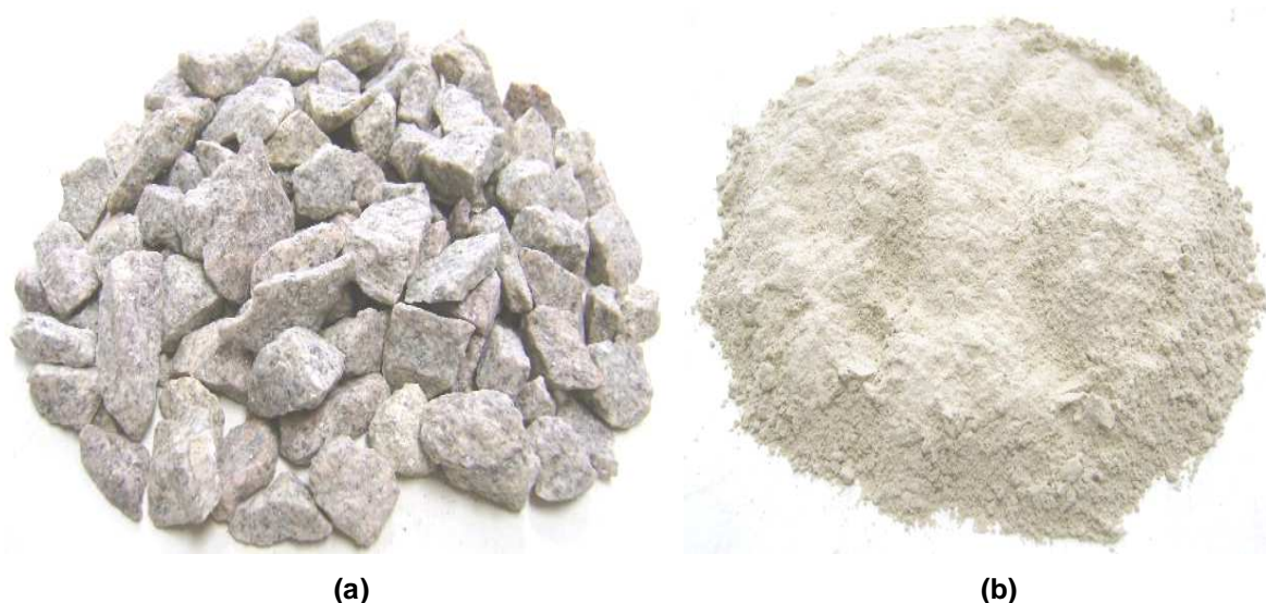
Figura 7.1 - Brita granítica: (a) fração grossa e (b) fíler.
