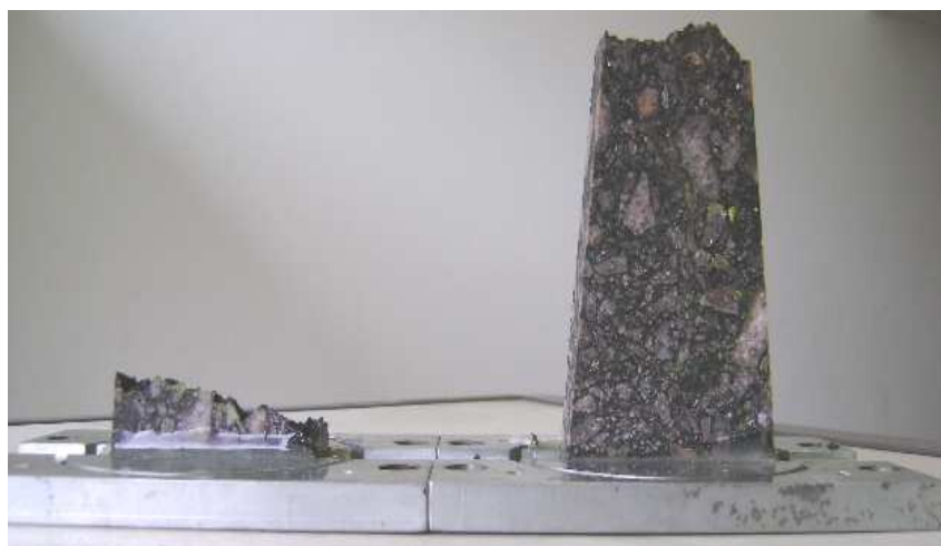
Figura 8.21 - Exemplo de corpo de prova (esquerda) rejeitado e (direita) aceito, de acordo com a zona de ruptura após os ensaios de fadiga.
