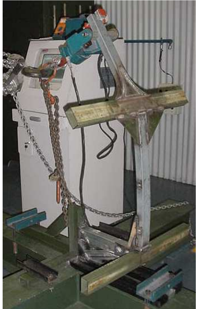
Figura 5.3: Configuração deformada final do corpo de provas ULB2F.
