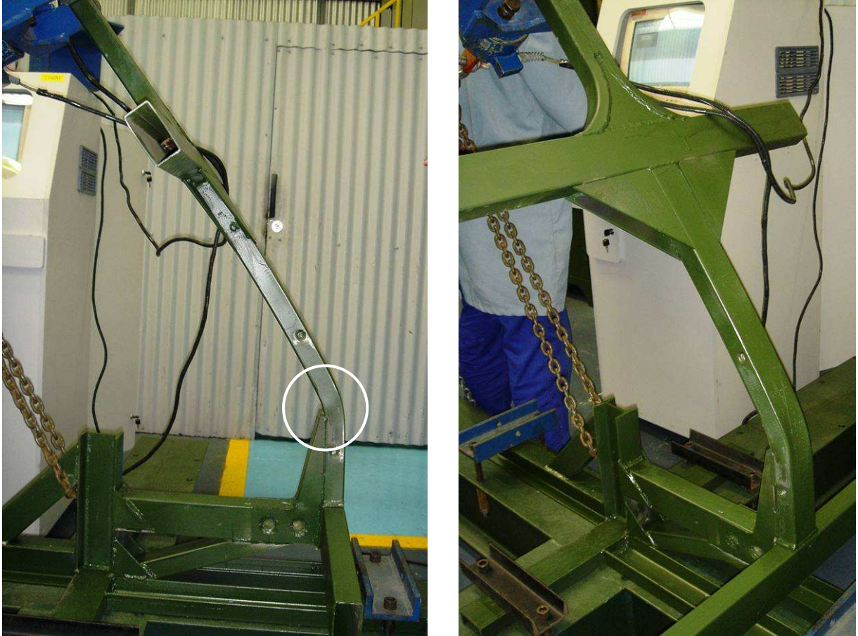
Figura 5.6: Configuração deformada final do corpo de provas ULB4F .
