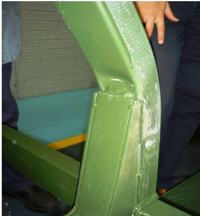
Figura 5.7: Detalhe da rótula plástica formada no corpo de provas ULB4F após o ensaio.
