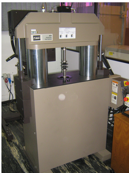
Figura 5.43: Máquina de ensaios dinâmicos - CETEPO.
