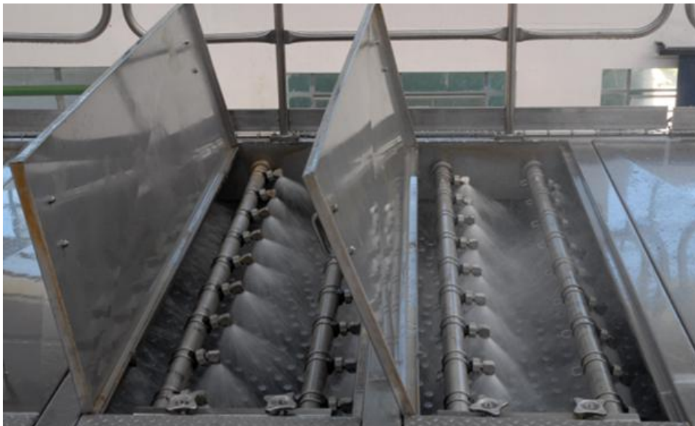
Figura 2.16. Vasilhames passando por um pasteurizador tipo túnel totalmente construído em aço inox e com esteira transportadora (cortesia de Ziemann-Liess Ltda.).
