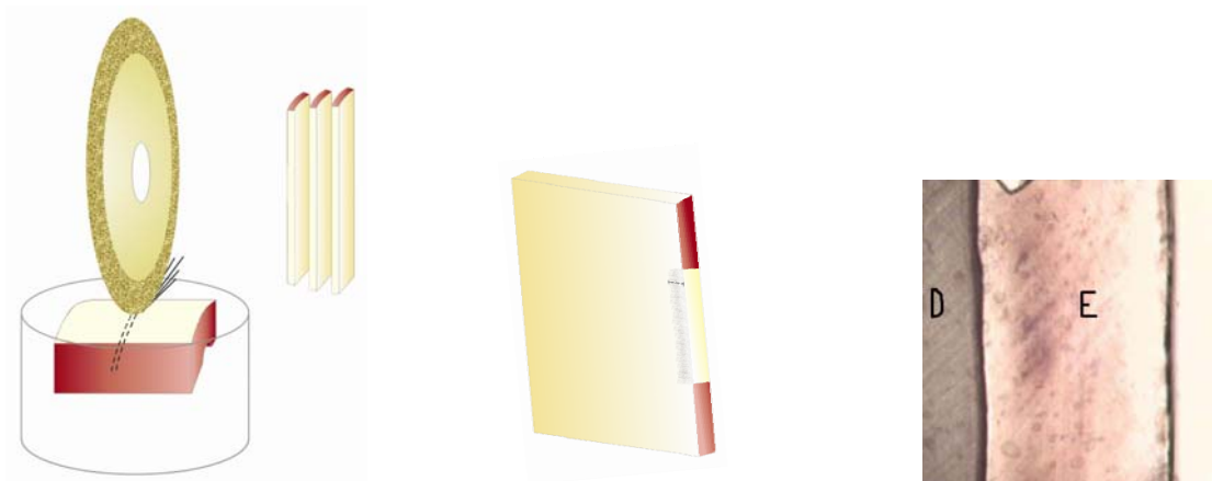
Figura 11. Esquema representativo do seccionamento dos fragmentos e análise de permeabilidade.
