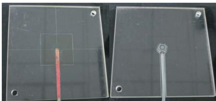
Figura 17: Placas desenvolvidas para acomodar o suporte com o fototransistor (à esquerda) e para acomodar a câmara Markus (à direita), com os respectivos detectores.
