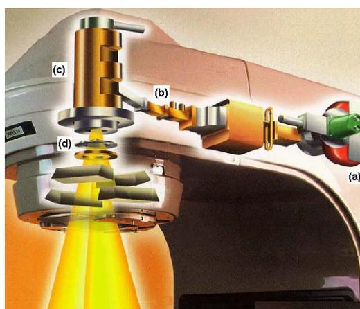
Figura 3: Esquema do acelerador linear Linac Varian 600C®. (a) Magnetron, (b) Sistema de Guia de Ondas, (c) Tubo Acelerador e (d) Alvo. Fonte: SALEMME, 2005
