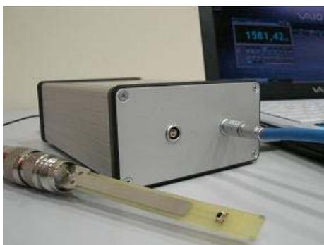
Figura 18: Sistema de detecção (Fototransistor no suporte ligado ao Eletrômetro Flip-Flop<sup>®</sup>, conectado ao computador de instrumentação). Fonte: SANTOS, 2007
