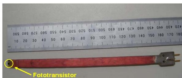
Figura 15: Fototransistor localizado no suporte.
