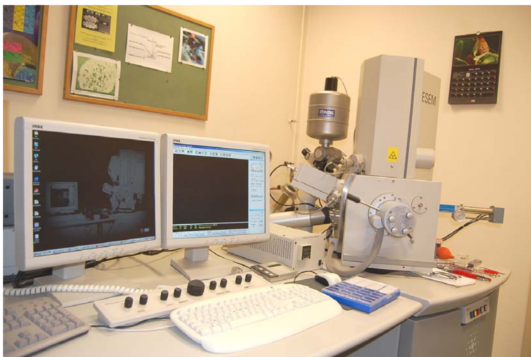
Figura 7 – Microscópio eletrônico de varredura acoplado à espectrofotômetro utilizado para as análises topográfica e química
