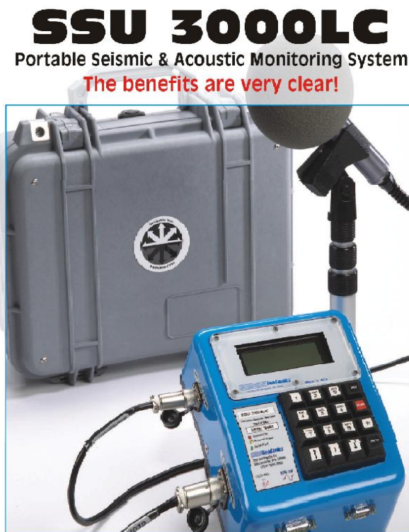
Foto V. 3 – Aparelho de medição da velocidade máxima da partícula (Fonte: MicroSonics)
