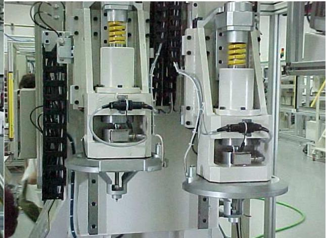
Figura 3.14 – Foto dos cabeçotes de medição.
