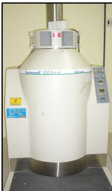
Figura 4 – Irradiador Gammacell ^{60}\text{Co} , utilizado na irradiação dos extratos brutos vegetais.
