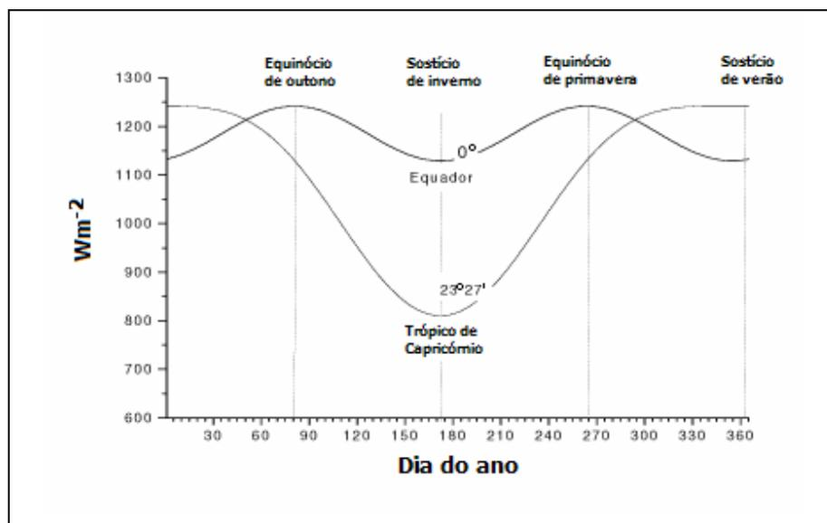
Figura 7 – Variação da intensidade da radiação solar que atinge a superfície terrestre na faixa intertropical do Hemisfério Sul no nível do mar (SILVA, 2006).
