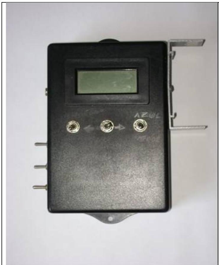
Figura 27 – Vista frontal do fotômetro montado
