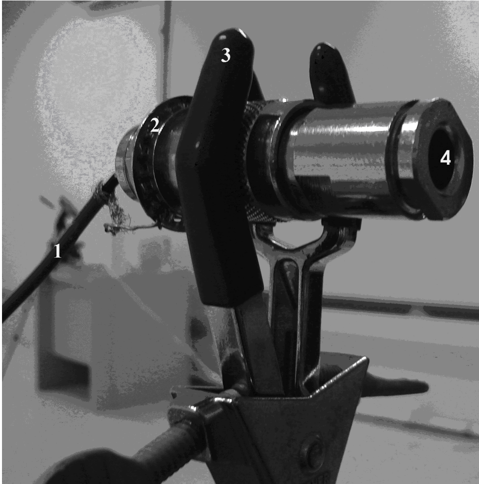
Figura 8: Blindagem do fototransistor na posição de irradiação. Legenda: 1 - Cabo PTFE conectado à saída da blindagem; 2 - Blindagem metálica; 3 - Suporte para o detector; 4 - Abertura por onde a radiação incide.
