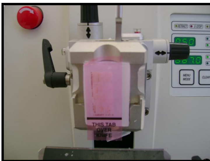
Figura 5: Equipamento que realiza cortes histológicos nos blocos de parafina para realização do TMA.
