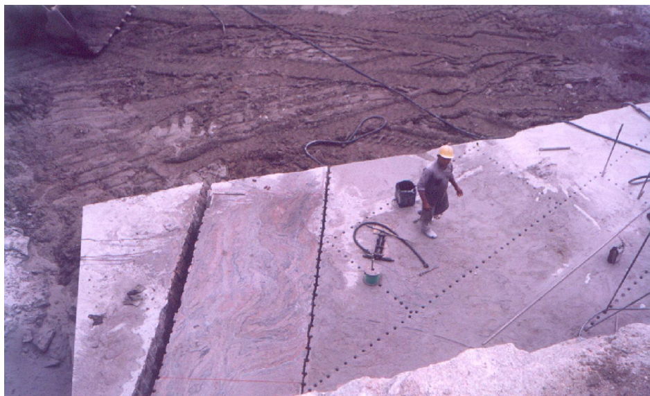
Figura 21: Recorte de blocos com martetele pneumático em assa expansiva.
