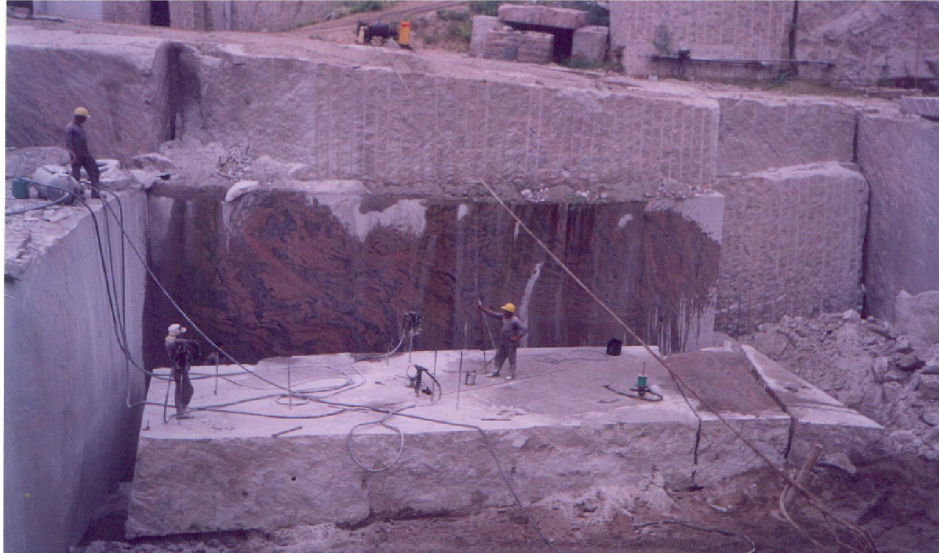
Figura 20: Frente de lavra da Pedreira P04.
