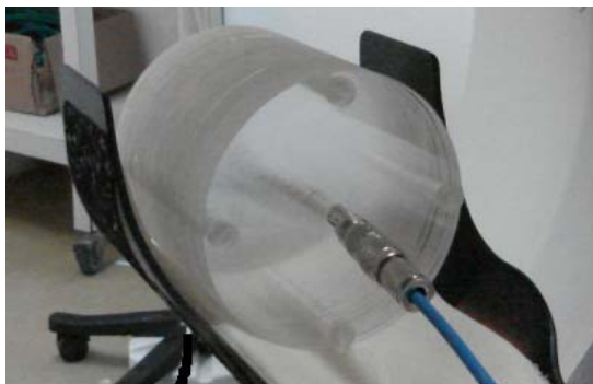
Figura 21: Arranjo experimental para avaliação da dose no simulador de cabeça.
