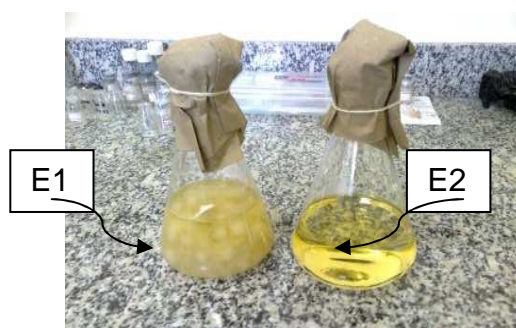
Figura 94- Reação de biorredução da Chalcona S3 (E1: Meio+fungo+substrato/ E2: meio de cultura)
