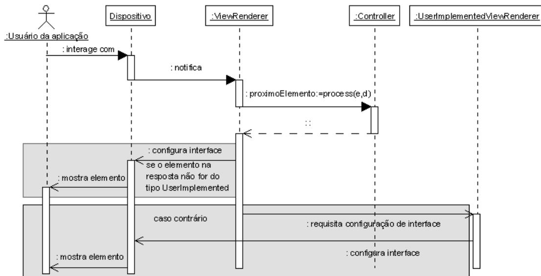
**Figura 7.1:** Diagrama de seqüência do núcleo do MobileVC
