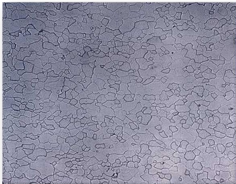
Figura 13: Microestrutura do material base da chapa a ser soldada, ataque nital 2%, 100 X
