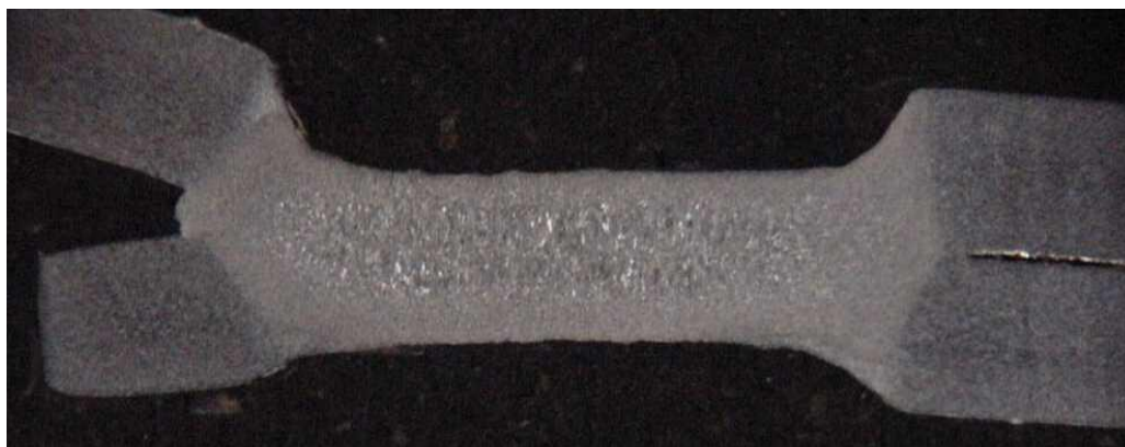
Figura 18: Seção transversal mostrando ponto de solda com indentação excessiva, ataque nital 2%, 40X (STOCCO, 2003).
