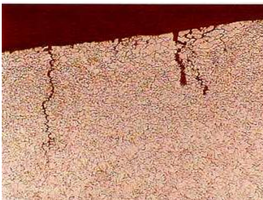
Figura 20: Seção transversal mostrando micro trincas na superfície do ponto de solda, ataque nital 2%, 200X (STOCCO, 2003).
