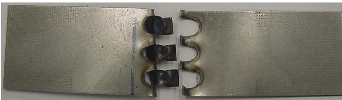
Figura 73: Aspecto do corpo de prova fraturado após o ensaio cíclico.
