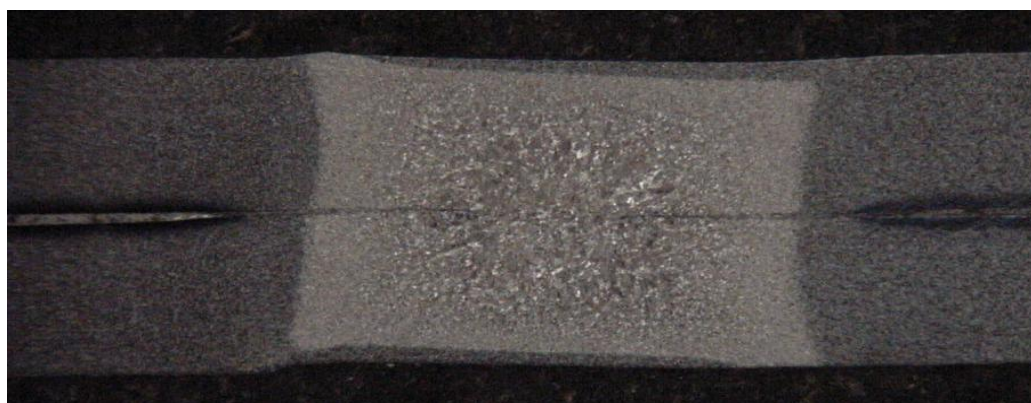
Figura 16: Seção transversal mostrando ponto com diâmetro abaixo do especificado, ataque nital 2%, 40X (STOCCO, 2003).
