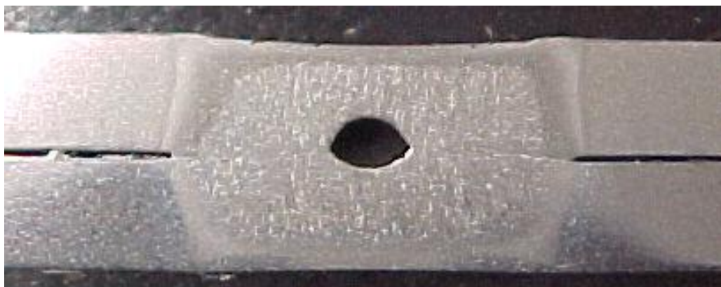
Figura 17: Seção transversal mostrando ponto de solda com descontinuidade interna, ataque nital 2%, 40X (DaimlerChrysler,2002).
