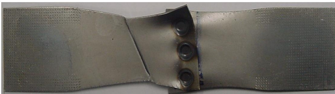
Figura 68: Aspecto do corpo de prova fraturado após ensaios de tração.
