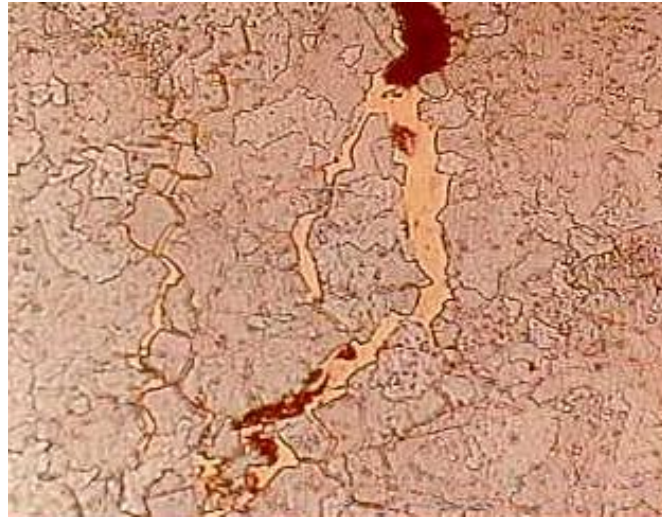
Figura 21: Seção transversal mostrando micro trinca na superfície do ponto de solda com incrustação de material base do eletrodo utilizado para a soldagem, ataque nital 2%, 500X (STOCCO, 2003).
