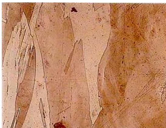
Figura 12: Seção transversal de eletrodo de liga Cu-Cr, com 200X de aumento (DaimlerChrysler,2002)
