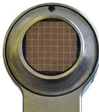
Figura 56: Imagem ampliada de transdutor matricial (DENISOV, 2004)
