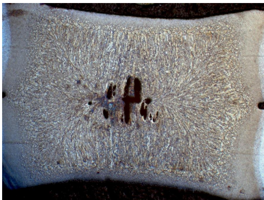
Figura 79: Metalografia da amostra 1, apresentando indicação de descontinuidade interna, confirmando o exame ultra-sônico, 50 X de aumento.
