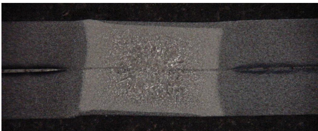
Figura 25: Seção transversal mostrando ponto com diâmetro abaixo do especificado, ataque nital 2%, 40X (STOCCO, 2003).
