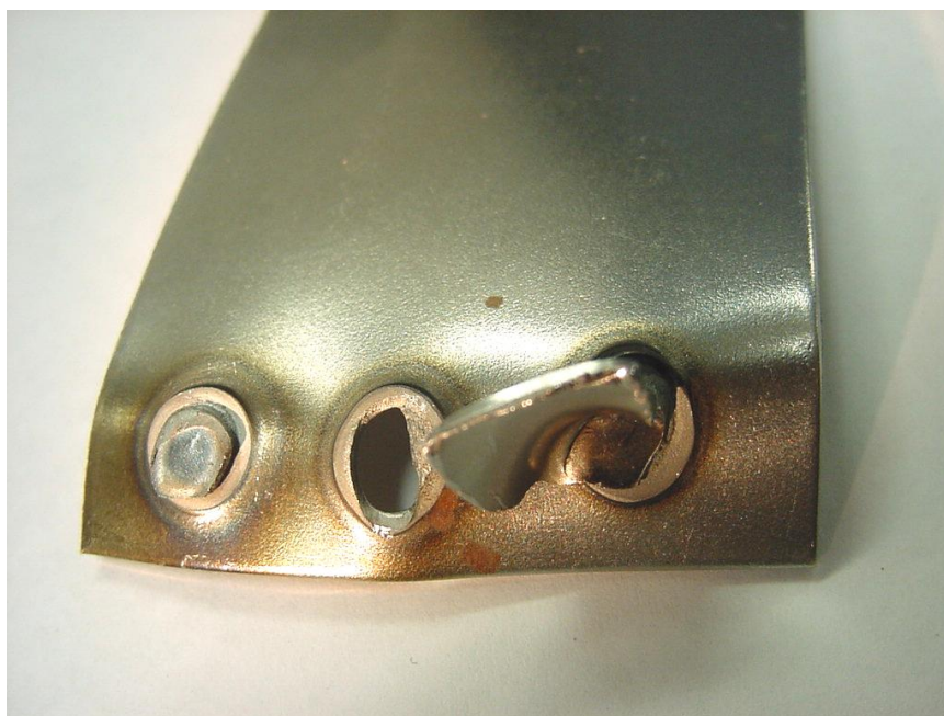
Figura 23: Corpo de prova soldado após ensaio de destacamento.
