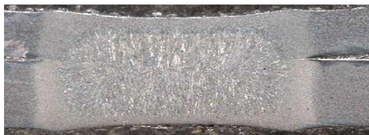
Figura 7: Seção transversal de um ponto soldado mostrando região fundida e zonas termicamente afetadas, ataque nital 2%, 50X (STOCCO, 2003)
