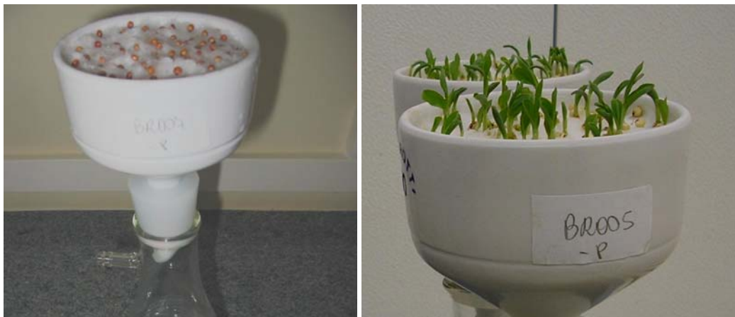
Figura 6: Sistema de cultivo adaptado para crescimento e coleta dos exsudados radiculares das plantas de sorgo.
