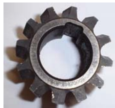
Figura 2.17 Seção de mistura dispersiva do tipo turbina.
