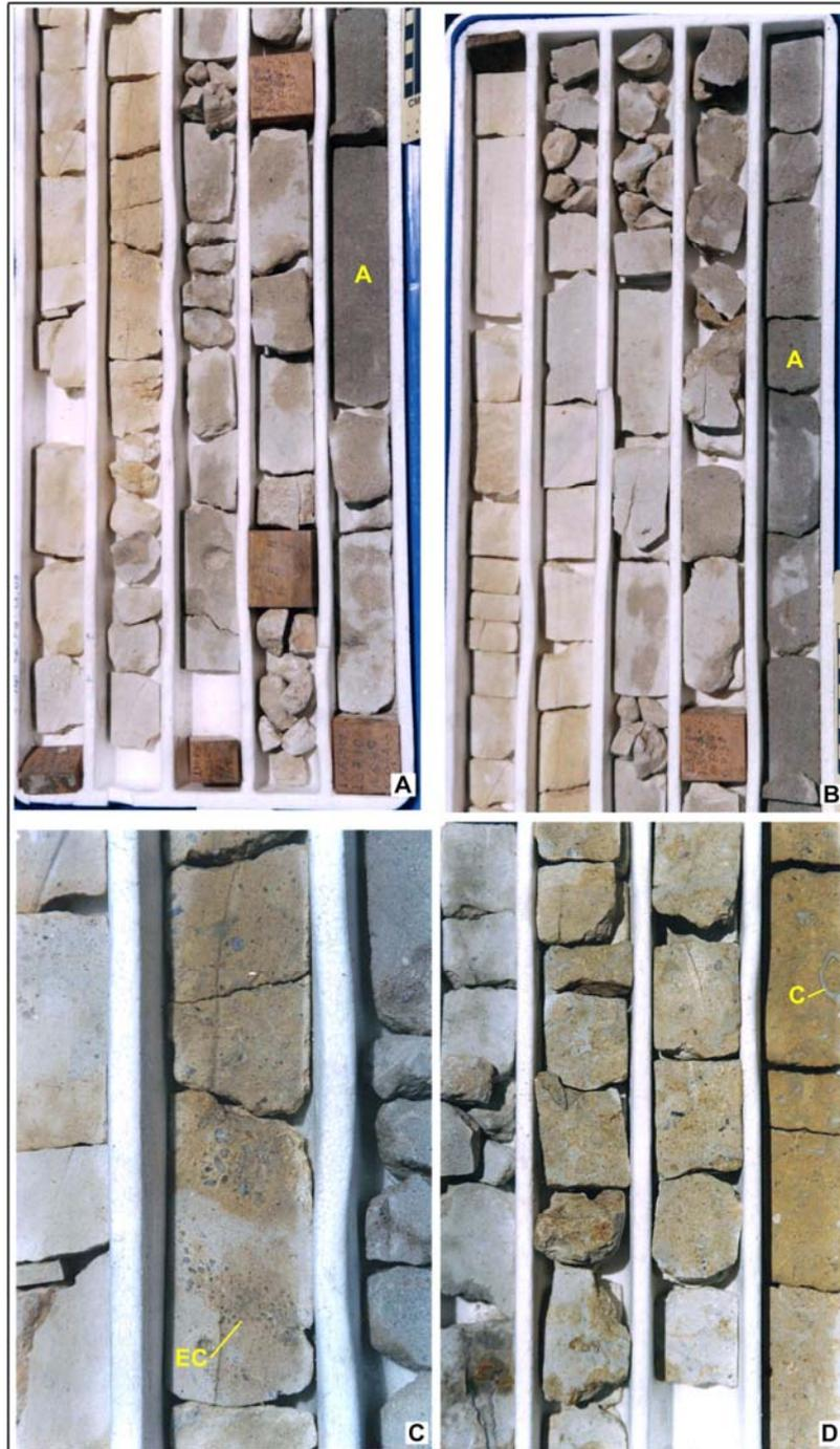
Figura VI.4 - Testemunho do poço 3 MA-01-PB, Mamanguape, Paraíba. Arenitos calcíferos e calcários com siliciclásticos da Formação Itamaracá. A = arenitos com forte cimentação carbonática, EC = estratificação cruzada de material siliciclástico, C = moldes de conchas) Diâmetro do testemunho = 4,0cm).
