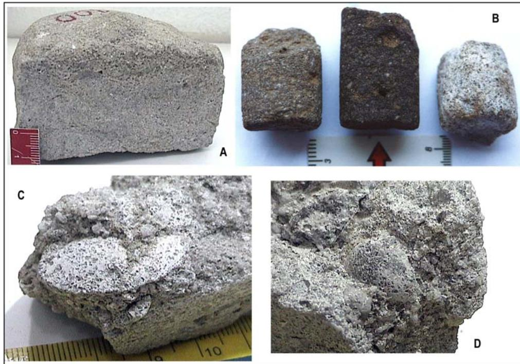
Figura VI.2 – Amostras de poços da Formação Beberibe. A) arenito fino a médio, mal selecionado, silicificado – poço 2 IST-01-PE (Itamaracá-PE); B) Arenito fino a médio, mal selecionado com cimento ferruginoso e silicificação – poço SRC-07 (Santa-Rita-PB). C) Arenito grosso, mal selecionado com grãos de feldspato de até 8mm, localmente argiloso, silicificado com molde de molusco bivalvío – poço P07 (Olinda-PE); D) detalhe da amostra vista em C mostrando aspecto da má seleção.
