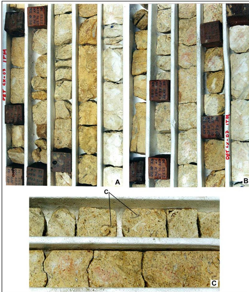
Figura VI.3 – Detalhes de testemunhos do poço 3 LU-02-PB, Lucena, Paraíba. As litologias representadas são arenitos calcíferos, bem litificados e calcários com siliciclásticos (C = fragmentos de conchas de moluscos misturadas ao material siliciclástico / diâmetro do testemunho = 4,0cm).
