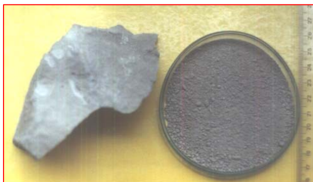
Figura 05 - Amostras do calcário inteiro e triturado para uso em ensaio.
