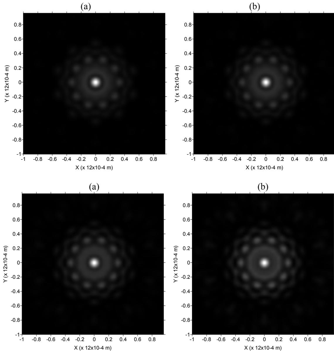
Figura 3.24. Padrões de difração gerados por cadeias de coroas com raio externo de  $100 \times 10^{-6} \text{ m}$  e raio interno de (a)  $10 \times 10^{-6} \text{ m}$ , (b)  $20 \times 10^{-6} \text{ m}$ , (c)  $30 \times 10^{-6} \text{ m}$  e (d)  $40 \times 10^{-6} \text{ m}$ , medido em  $z = 150 \times 10^{-3} \text{ m}$ .
