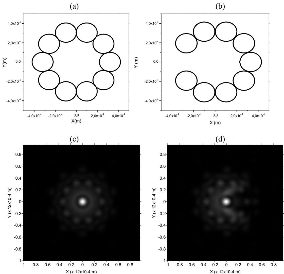
Figura 3.26. Padrão de difração gerado por uma cadeia de 10 fendas com raio de  $100 \times 10^{-6} m$ , com raio da geratriz sendo igual a  $3,3 \times$  raio da fenda elementar e a exclusão de um elemento da cadeia, medido em  $z = 200 \times 10^{-3} m$ .
