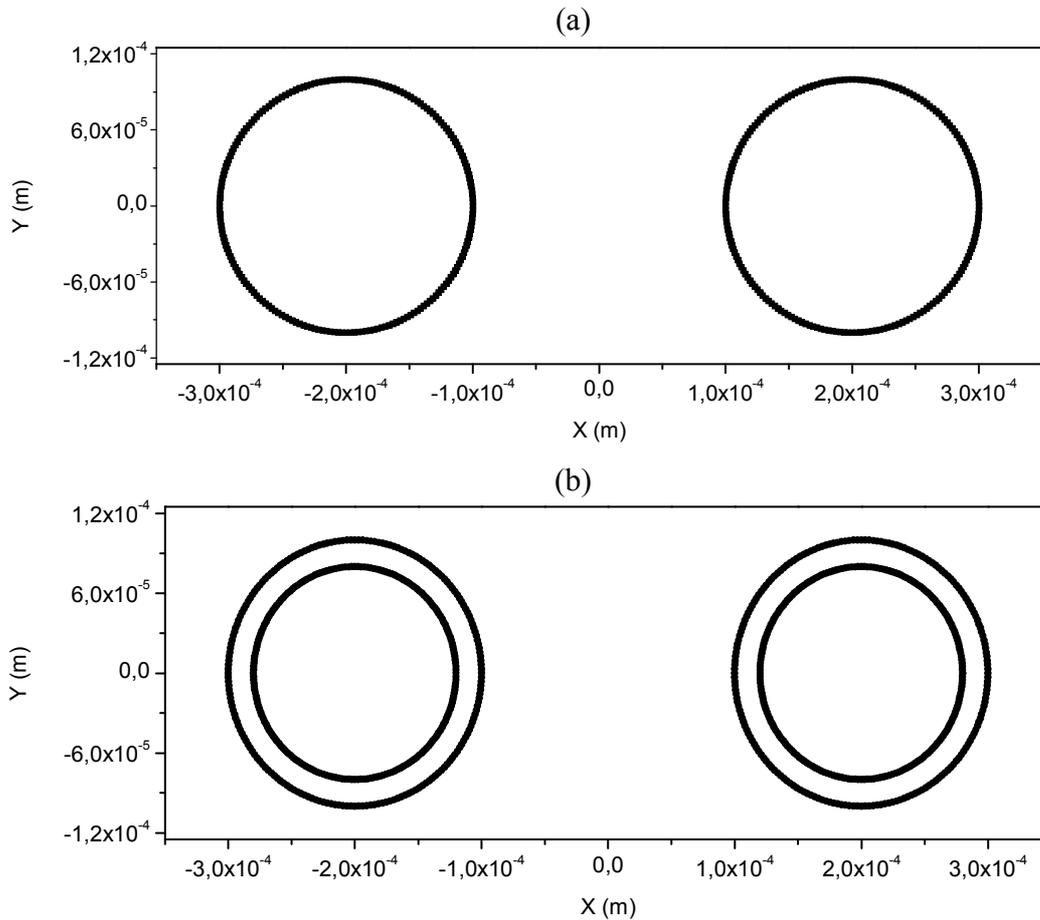
Figura 3.7. (a) Duas fendas elementares com raio de  $100 \times 10^{-6} m$  e (b) duas coroas com raio externo  $100 \times 10^{-6} m$  e raio interno  $80 \times 10^{-6} m$ , ambas separadas por uma distância igual à  $2 \times$  raio da fenda elementar.
