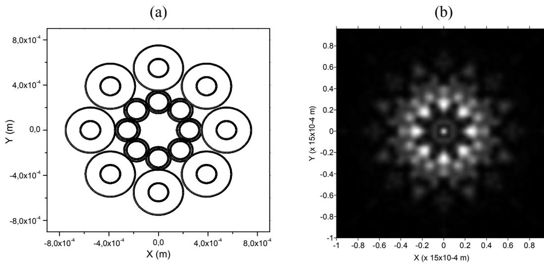
Figura 3.54. Cadeira com duas geratrizes de oito coroas. Geratriz interna com coroas de raio interno  $80 \times 10^{-6} \text{ m}$  e raio externo  $100 \times 10^{-6} \text{ m}$ . E a geratriz externa com coroas de raio interno também de  $80 \times 10^{-6} \text{ m}$  e raio externo de  $200 \times 10^{-6} \text{ m}$ , medido em  $z = 200 \times 10^{-3} \text{ m}$ .
