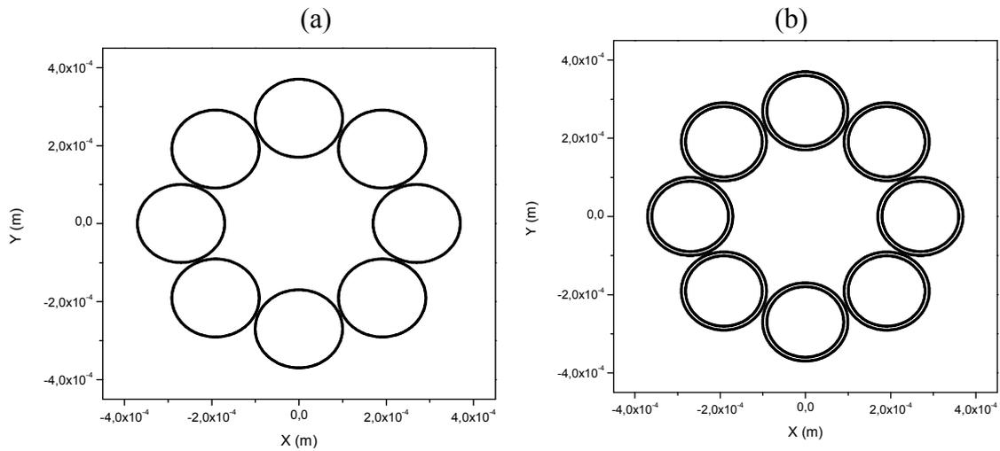
Figura 3.12. (a) Cadeia de fendas com raio de  $100 \times 10^{-6} \text{ m}$  formando uma geratriz de raio igual à  $2,7 \times$  raio da fenda elementar, e (b) cadeia de coroas com raio externo  $100 \times 10^{-6} \text{ m}$  e raio interno  $80 \times 10^{-6} \text{ m}$  formando uma geratriz de raio também igual a  $2,7 \times$  raio da fenda elementar.
