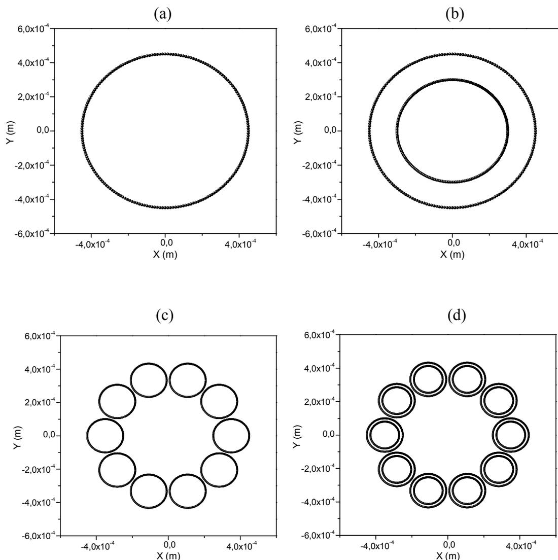
Figura 3.21. (a) Fenda elementar de raio  $4,5 \times 10^{-4} m$ . (b) Coroa de raios externo e interno  $4,5 \times 10^{-4} m$  e  $3,5 \times 10^{-4} m$ , respectivamente. (c) Cadeia de fendas com raio de  $100 \times 10^{-6} m$  e raio da geratriz igual à  $4,5 \times 10^{-4} m$ . (d) Cadeia de coroas com raios externo e interno de  $100 \times 10^{-6} m$  e  $80 \times 10^{-6} m$ , respectivamente.
