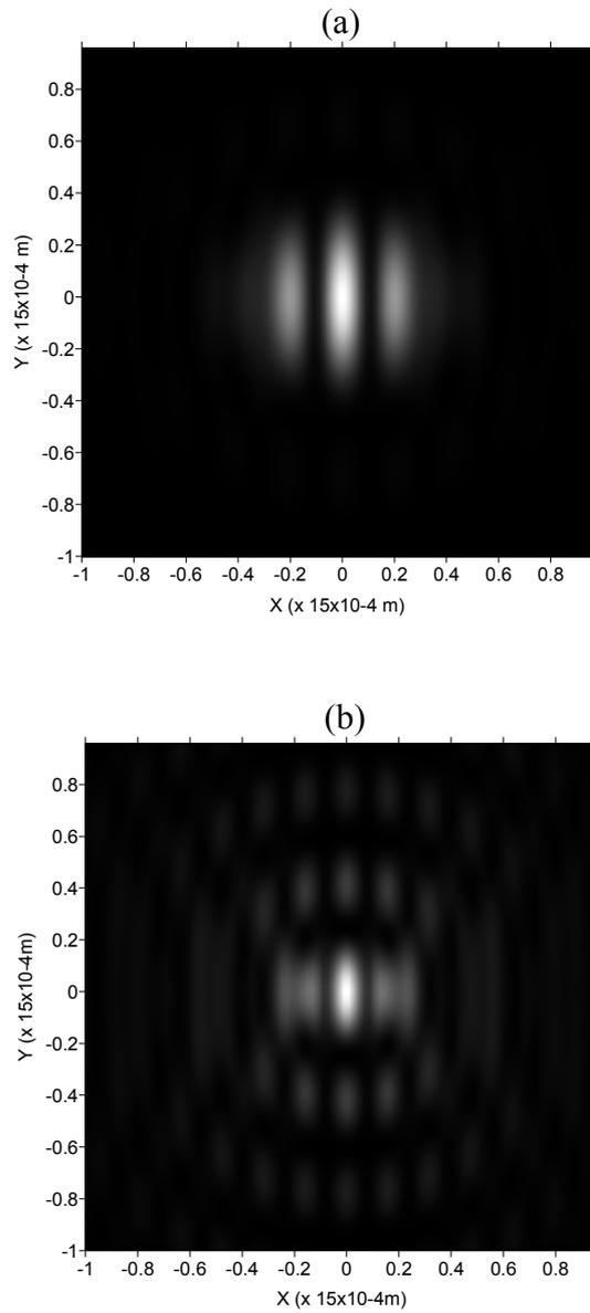
Figura 3.8. Padrão de difração gerado pela configuração de fendas (a) e coroas (b) mostradas na Figura 3.7 medido em  $z = 150 \times 10^{-3} m$ .
