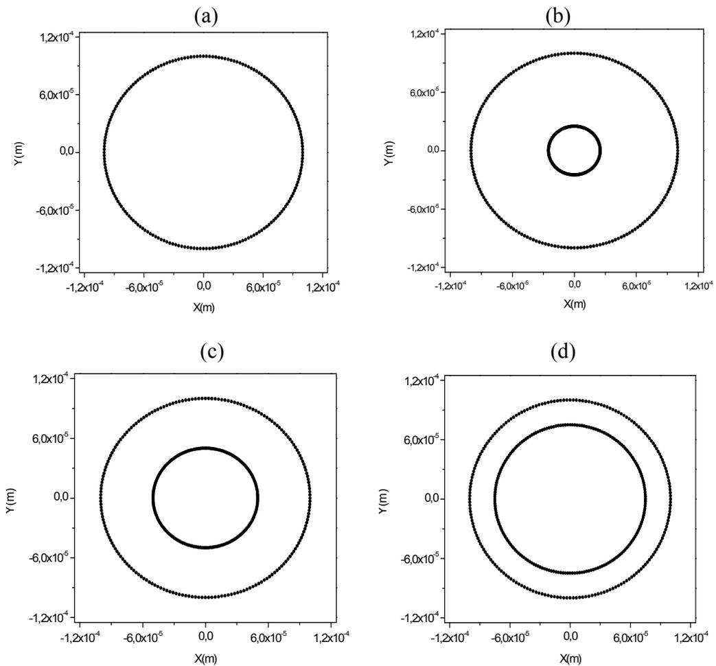
Figura 3.1. Configuração dos planos de difração com coroas de raio externo igual à  $100 \times 10^{-6} m$  e raio interno: (a) zero; (b)  $25 \times 10^{-6} m$ ; (c)  $50 \times 10^{-6} m$  e (d)  $75 \times 10^{-6} m$ .
