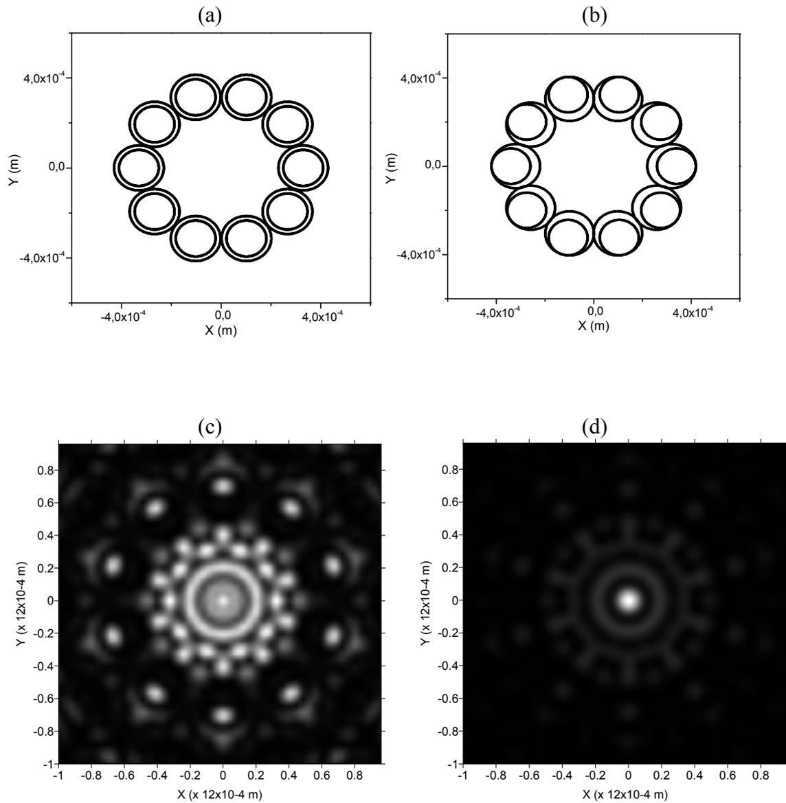
Figura 3.51. Cadeia de coroas com deslocamento de  $2,5 \times 10^{-1} \times \text{raio interno}$  em função do ângulo do centro das fendas medido em  $z = 150 \times 10^{-3} \text{ m}$ .
