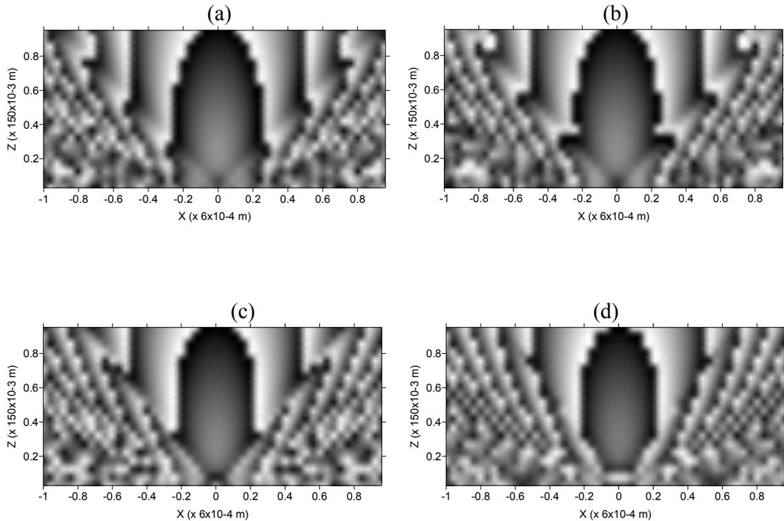
Figura 3.6. Configuração da fase no plano de propagação XZ, gerada por coroas circulares de raio externo  $100 \times 10^{-6} m$  e raio interno: (a) zero; (b)  $25 \times 10^{-6} m$ ; (c)  $50 \times 10^{-6} m$  e (d)  $75 \times 10^{-6} m$ , medida entre  $z = 4,5 \times 10^{-3} m$  e  $z = 150 \times 10^{-3} m$ .
