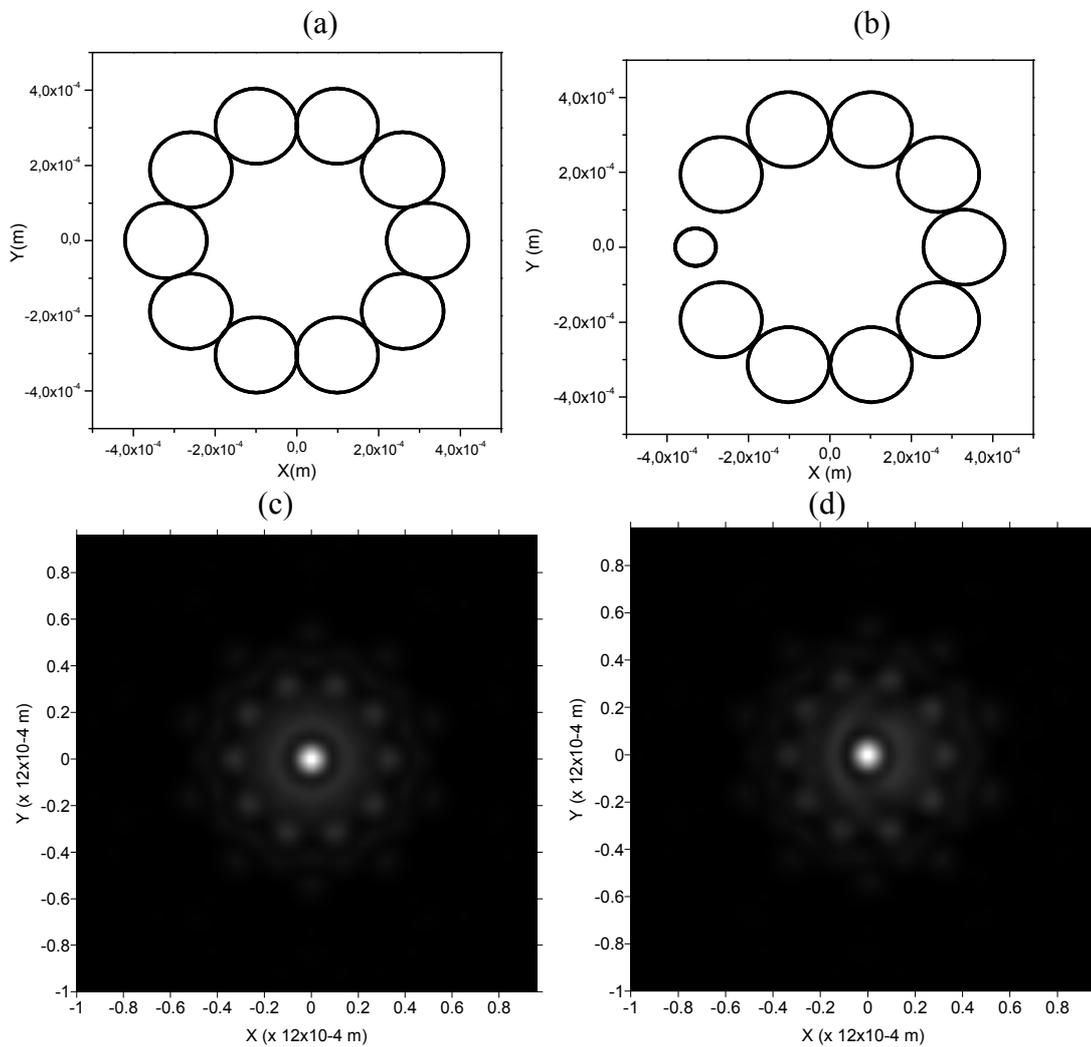
Figura 3.28. Padrão de difração gerado por uma cadeia de 10 fendas com raio elementar de  $100 \times 10^{-6} m$ , com raio da geratriz sendo igual a  $3,3 \times$  raio da fenda elementar e a inclusão de um elemento com raio igual  $0,5 \times$  raio da fenda elementar na cadeia, medido em  $z = 200 \times 10^{-3} m$ .
