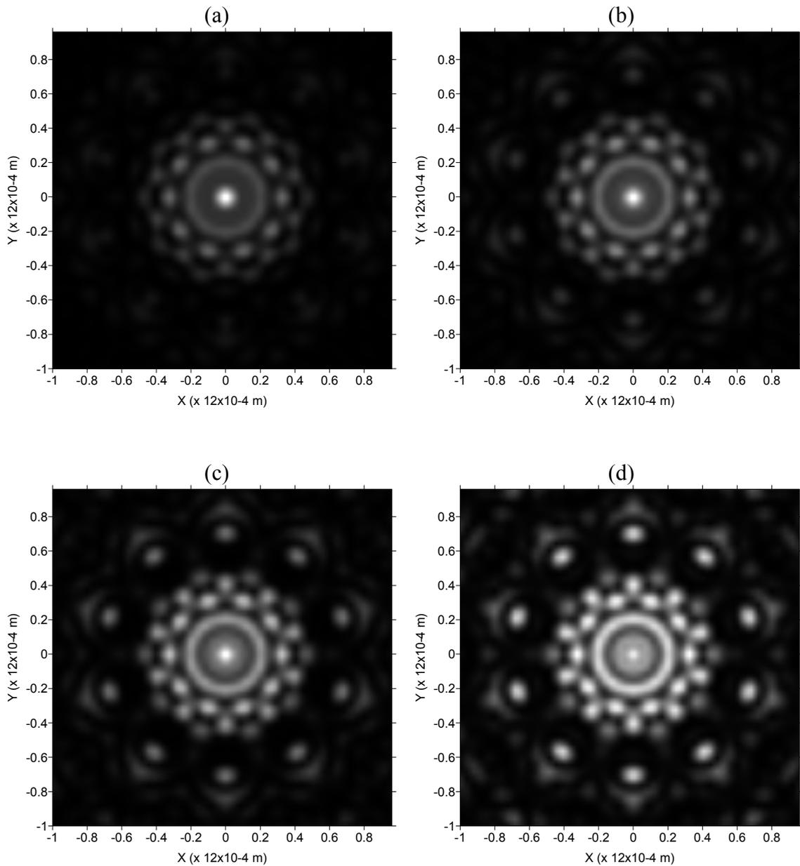
Figura 3.25. Padrões de difração gerados por cadeias de coroas com raio externo de  $100 \times 10^{-6} m$  e raio interno de (a)  $50 \times 10^{-6} m$ , (b)  $60 \times 10^{-6} m$ , (c)  $70 \times 10^{-6} m$  e (d)  $80 \times 10^{-6} m$ , medido em  $z = 150 \times 10^{-3} m$ .
