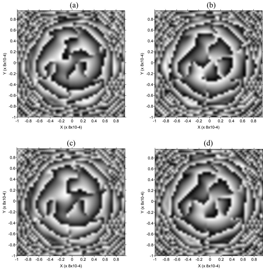
Figura 3.19. Configuração da fase no plano  $xy$  gerado por uma cadeia formada por 6 fendas de raio  $100 \times 10^{-6} m$ , medido em (a)  $z = 150 \times 10^{-3} m$ , (b)  $z = 151 \times 10^{-3} m$ , (c)  $z = 152 \times 10^{-3} m$  e (d)  $z = 153 \times 10^{-3} m$ , com fase inicial da onda plana incidente igual a  $0,8 \pi$ .
