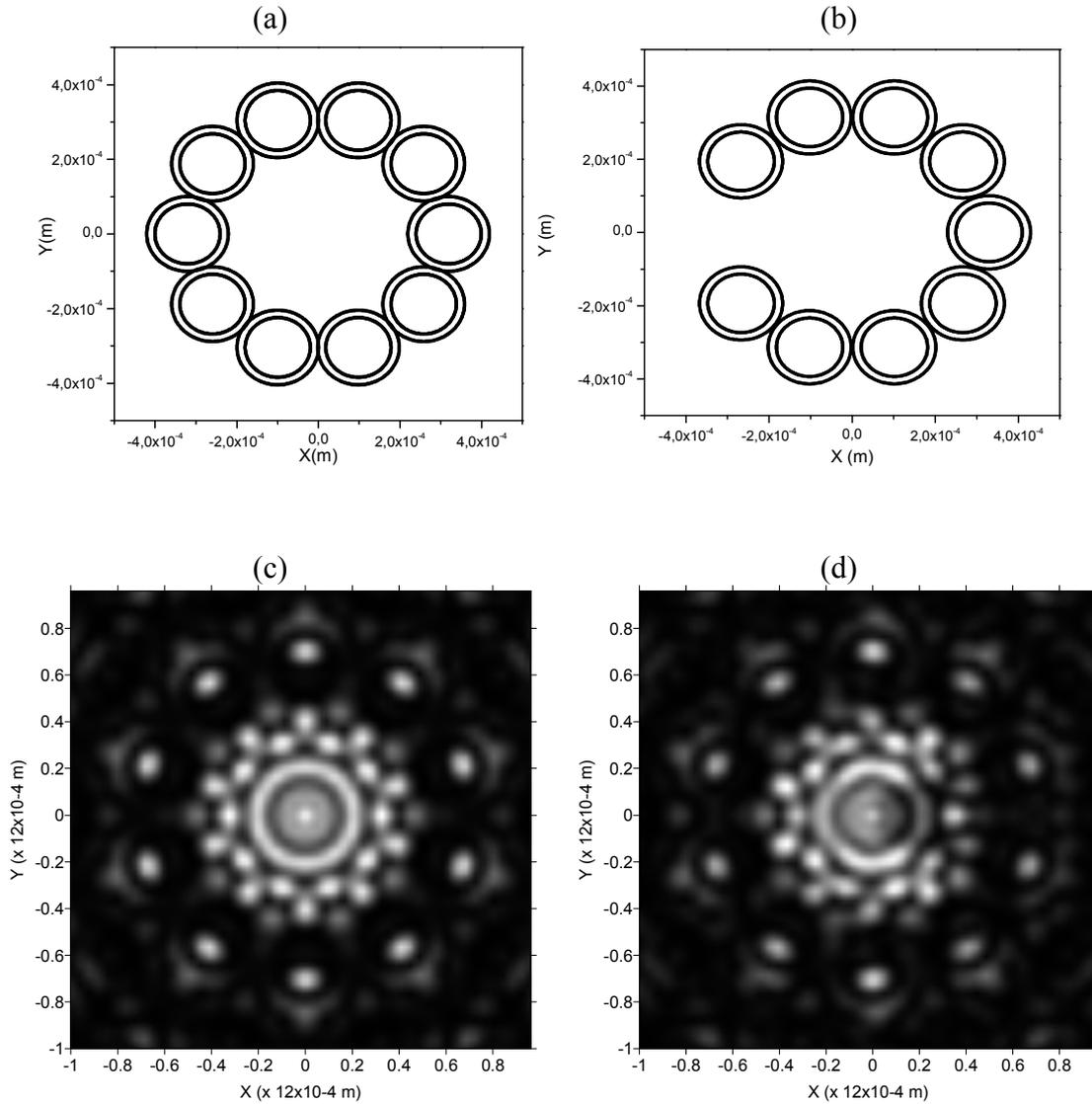
Figura 3.27. Padrão de difração gerado por uma cadeia de 10 coroas com raio externo de  $100 \times 10^{-6} m$  e raio interno  $80 \times 10^{-6} m$ , com raio da geratriz sendo igual a  $3,3 \times$  raio da fenda elementar e a exclusão de um elemento da cadeia, medido em  $z = 200 \times 10^{-3} m$ .
