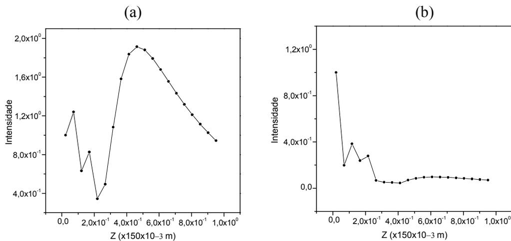
Figura 3.15. Intensidade de pico durante a propagação ao longo da direção z de uma cadeia formada por (a) oito fendas elementares de raio  $100 \times 10^{-6} \text{ m}$  com raio da geratriz igual a  $2,6 \times$  raio da fenda elementar e (b) oito coroas de raio externo  $100 \times 10^{-6} \text{ m}$  e raio interno  $80 \times 10^{-6} \text{ m}$  com mesmo raio da geratriz, medida de  $z = 6 \times 10^{-3} \text{ m}$  até  $z = 300 \times 10^{-3} \text{ m}$ .
