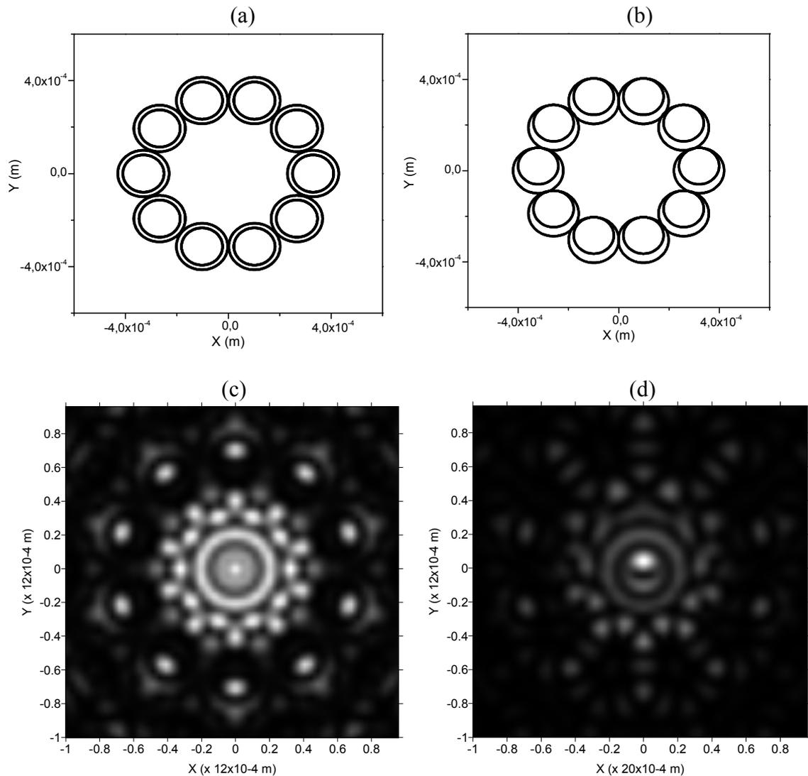
Figura 3.50. Deslocamento de  $2,5 \times 10^{-1} \times \text{raio interno}$  do centro de cada circunferência interna em relação à externa numa cadeia de coroas com raio externo de  $100 \times 10^{-6} \text{ m}$  e raio interno de  $80 \times 10^{-6} \text{ m}$  no eixo  $y$ , medidos em  $z = 150 \times 10^{-3} \text{ m}$ .
