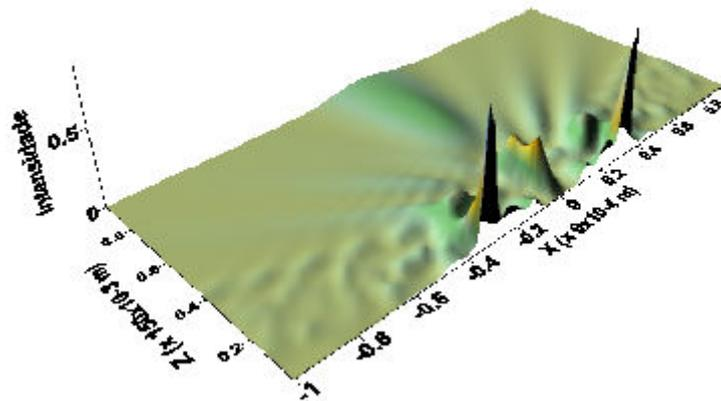
Figura 3.14. Intensidade do feixe durante a propagação ao longo da direção  $z$  de uma cadeia formada por (a) oito fendas elementares de raio  $100 \times 10^{-6} m$  com raio da geratriz igual a  $2,6 \times$  raio da fenda elementar e (b) oito coroas de raio externo  $100 \times 10^{-6} m$  e raio interno  $80 \times 10^{-6} m$  com mesmo raio da geratriz, medida de  $z = 6 \times 10^{-3} m$  até  $z = 150 \times 10^{-3} m$ .
