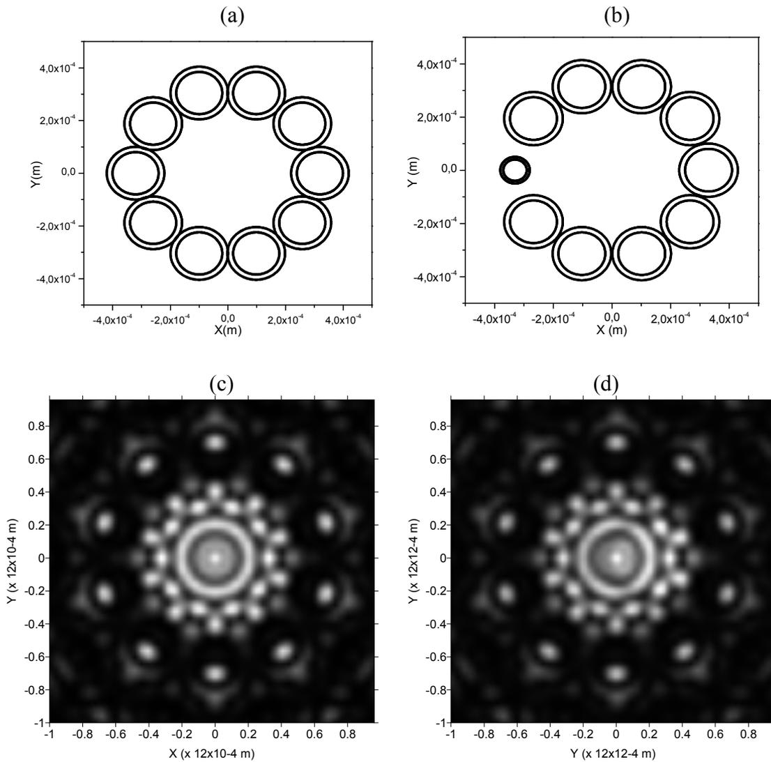
Figura 3.29. Padrão de difração gerado por uma cadeia de 10 coroas com raio externo de  $100 \times 10^{-6} m$  e raio interno  $80 \times 10^{-6} m$ , com raio da geratriz sendo igual a  $3,3 \times$  raio da fenda elementar e a inclusão de um elemento com raio igual  $0,5 \times$  raio da fenda elementar na cadeia, medido em  $z = 200 \times 10^{-3} m$ .
