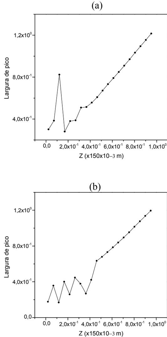
Figura 3.16. Variação da largura de pico em função da distância no eixo z durante a propagação ao longo da direção z de uma cadeia formada por (a) oito fendas elementares de raio  $100 \times 10^{-6} m$  com raio da geratriz igual a  $2,6 \times$  raio da fenda elementar e (b) oito coroas de raio externo  $100 \times 10^{-6} m$  e raio interno  $80 \times 10^{-6} m$  com mesmo raio da geratriz, medida de  $z = 6 \times 10^{-3} m$  até  $z = 300 \times 10^{-3} m$ .
