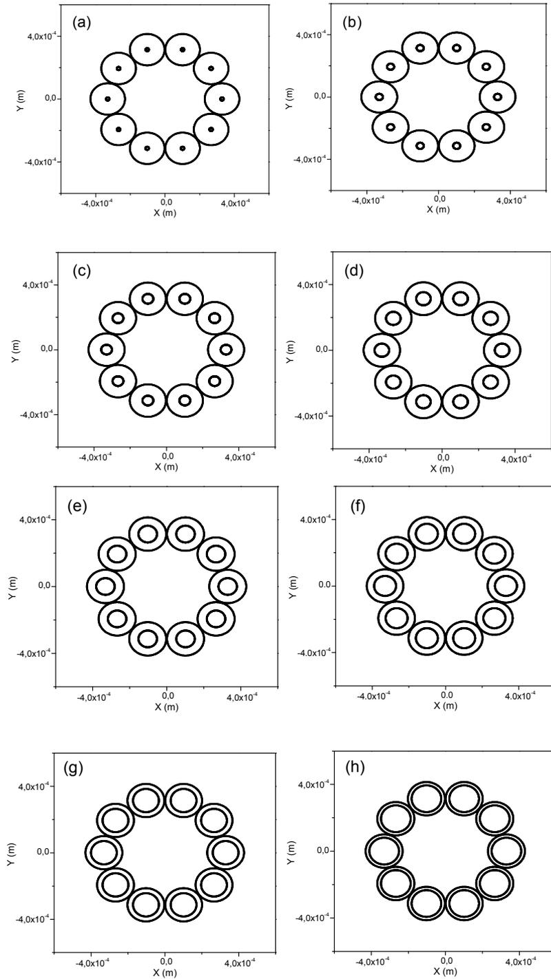
Figura 3.23. Cadeias de 10 coroas com raio externo de  $100 \times 10^{-6} m$  e raio interno de (a)  $10 \times 10^{-6} m$ , (b)  $20 \times 10^{-6} m$ , (c)  $30 \times 10^{-6} m$ , (d)  $40 \times 10^{-6} m$ , (e)  $50 \times 10^{-6} m$ , (f)  $60 \times 10^{-6} m$ , (g)  $70 \times 10^{-6} m$  e (h)  $80 \times 10^{-6} m$ .
