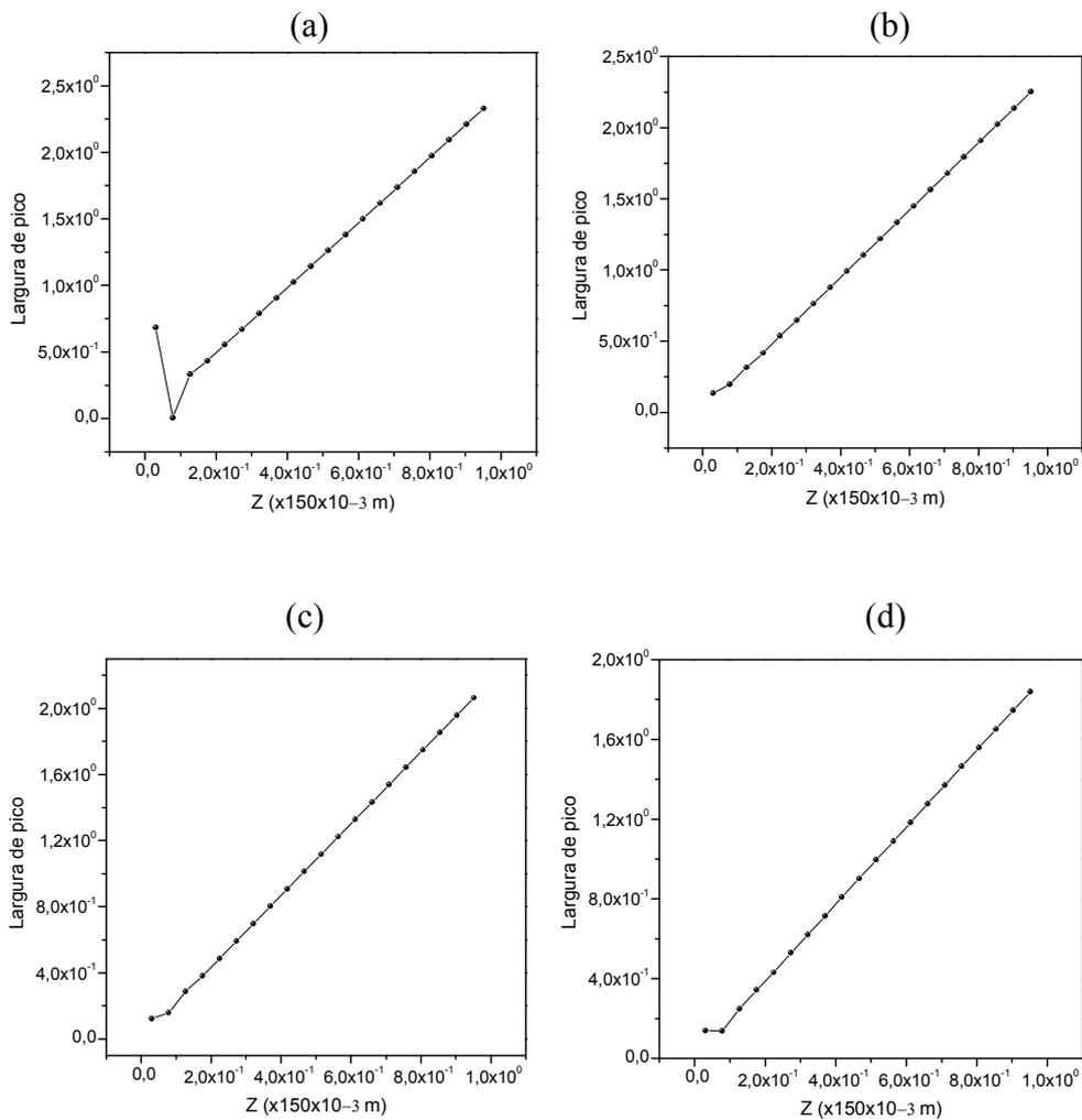
Figura 3.5. Variação da largura de pico em função da distância no eixo z, gerada por coroas circulares de raio externo  $100 \times 10^{-6} \text{ m}$  e raio interno: (a) zero; (b)  $25 \times 10^{-6} \text{ m}$ ; (c)  $50 \times 10^{-6} \text{ m}$  e (d)  $75 \times 10^{-6} \text{ m}$ , medida entre  $z = 4,5 \times 10^{-3} \text{ m}$  e  $z = 150 \times 10^{-3} \text{ m}$ .
