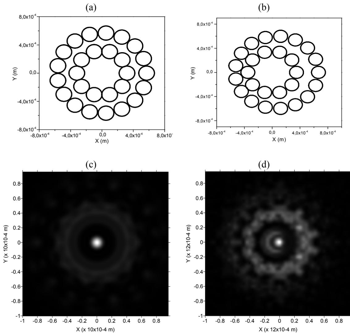
Figura 3.52. Comparação entre uma cadeia de fendas com duas geratrizes com centros das geratrizes coincidindo (a) e uma cadeia de fendas com raio de  $100 \times 10^{-6} m$  com duas geratrizes com deslocamento do centro da geratriz interna em relação à externa (b).
