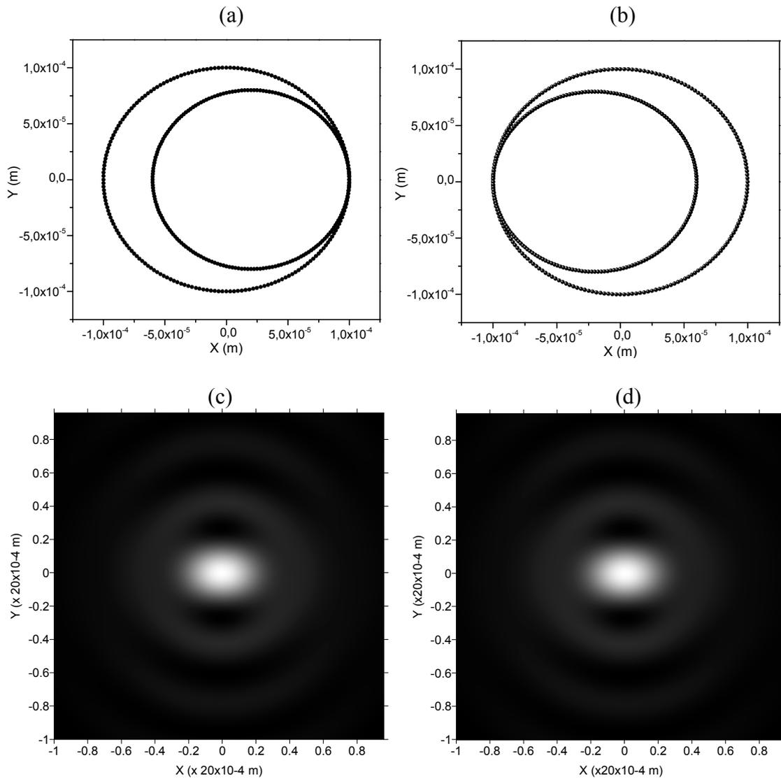
Figura 3.48. Deslocamento de  $2,5 \times 10^{-1} \times \text{raio interno}$  do centro da circunferência interna em relação à externa numa coroa com raio externo de  $100 \times 10^{-6} \text{ m}$  e raio interno de  $80 \times 10^{-6} \text{ m}$  (a) e deslocamento de  $-2,5 \times 10^{-1} \times \text{raio interno}$  (b), no eixo  $x$ . (c) Padrão de difração gerado pela fenda (a), e (d) padrão de difração gerado pela fenda (b) medidos em  $z = 200 \times 10^{-3} \text{ m}$ .
