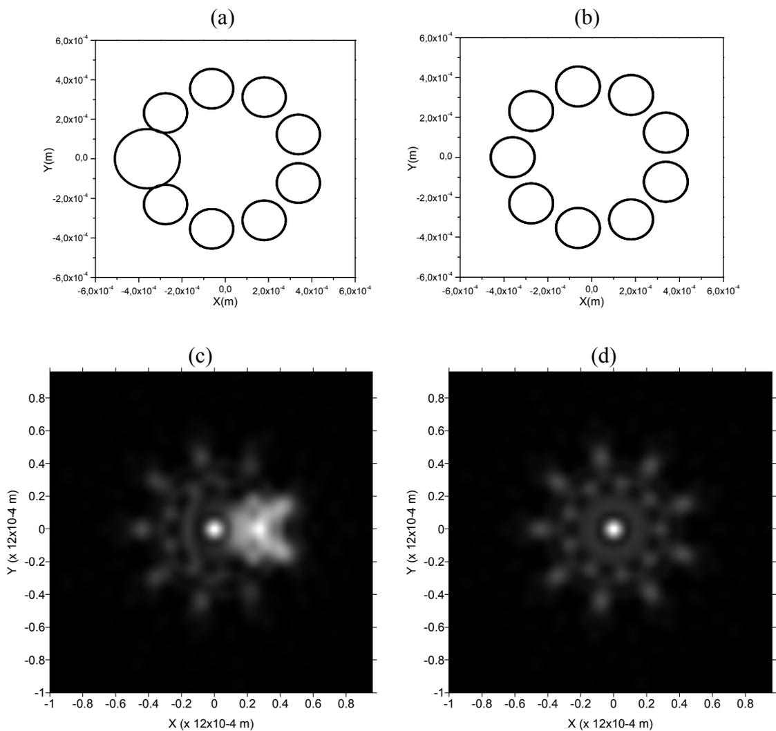
Figura 3.30. Padrão de difração gerado por uma cadeia de nove fendas com raio de  $100 \times 10^{-6} m$ , com raio da geratriz sendo igual a  $3,6 \times$  raio da fenda elementar e a inclusão de uma fenda com raio igual à  $1,5 \times$  raio da fenda elementar medido em  $z = 150 \times 10^{-6} m$ .
