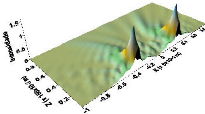
Figura 3.9. Intensidade do feixe durante a propagação ao longo da direção  $z$  de uma cadeia formada por (a) duas fendas de raio  $100 \times 10^{-6} m$  separadas por uma distância de  $2 \times 10^{-4} m$  e (b) duas coroas de raio externo  $100 \times 10^{-6} m$  e raio interno  $80 \times 10^{-6} m$  também separadas por uma distância de  $2 \times 10^{-4} m$ , medida de  $z = 4,5 \times 10^{-3} m$  até  $z = 150 \times 10^{-3} m$ .
