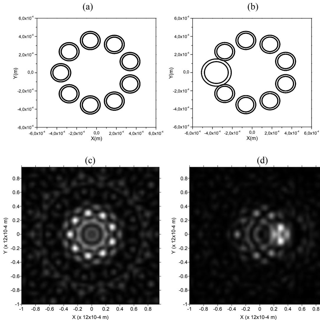
Figura 3.31. Padrão de difração gerado por uma cadeia de 9 coroas com raio interno de  $80 \times 10^{-6} m$  e externo de  $100 \times 10^{-6} m$  com raio da geratriz sendo igual a  $3,6 \times$  raio da fenda elementar e a inclusão de uma fenda com raio igual à  $1,5 \times$  raio da fenda elementar medido em  $z = 150 \times 10^{-6} m$ .
