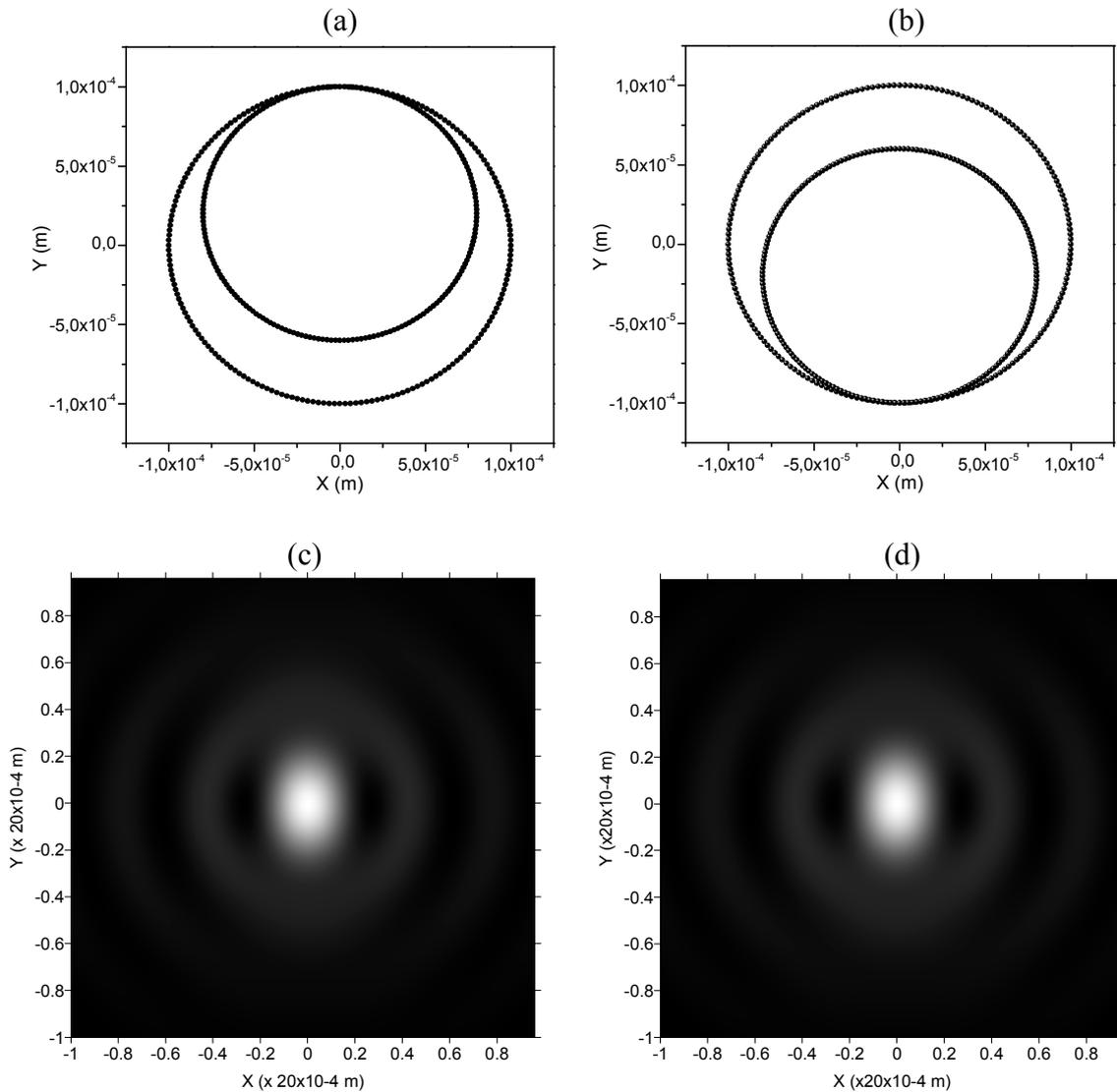
Figura 3.49. Deslocamento de  $2,5 \times 10^{-1} \times \text{raio interno}$  do centro da circunferência interna em relação à externa numa coroa com raio externo de  $100 \times 10^{-6} \text{ m}$  e raio interno de  $80 \times 10^{-6} \text{ m}$  (a) e deslocamento de  $-2,5 \times 10^{-1} \times \text{raio interno}$  (b), no eixo  $y$ . (c) Padrão de difração gerado pela fenda (a), e (d) padrão de difração gerado pela fenda (b) medidos em  $z = 200 \times 10^{-3} \text{ m}$ .
