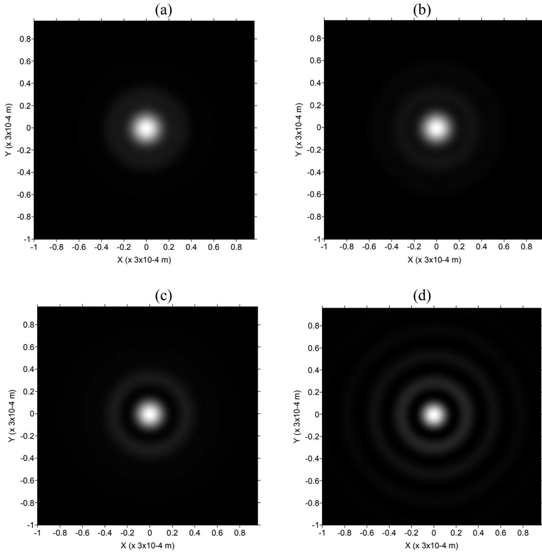
Figura 3.2. Comparação entre os perfis de intensidade gerados por coroas circulares com raio externo igual  $100 \times 10^{-6} m$  e raio interno: (a) zero; (b)  $25 \times 10^{-6} m$ ; (c)  $50 \times 10^{-6} m$  e (d)  $75 \times 10^{-6} m$ , medidos em  $z = 150 \times 10^{-3} m$ .
