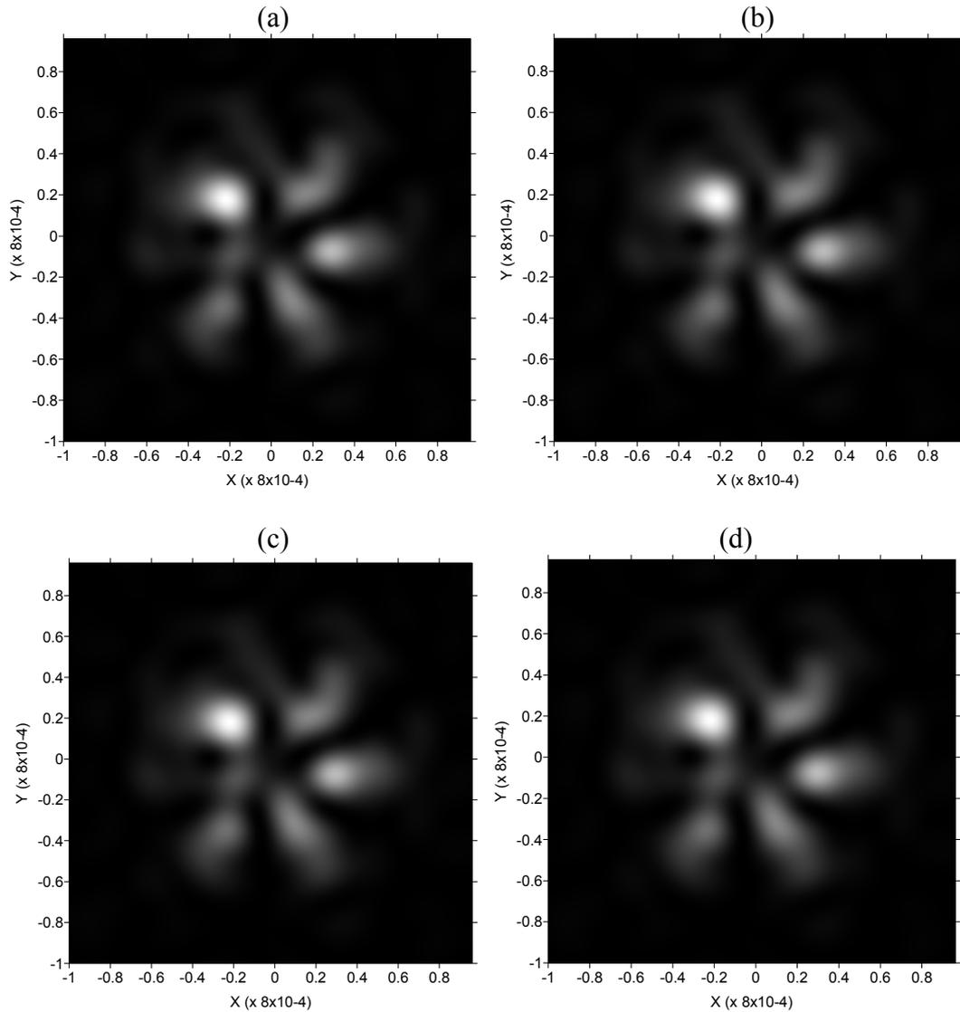
Figura 3.18. Padrão de difração gerado por uma cadeia formada por 6 fendas de raio  $100 \times 10^{-6} m$ , medido em (a)  $z = 150 \times 10^{-3} m$ , (b)  $z = 151 \times 10^{-3} m$ , (c)  $z = 152 \times 10^{-3} m$  e (d)  $z = 153 \times 10^{-3} m$ , com fase inicial da onda plana incidente igual a  $0,8 \pi$ .
