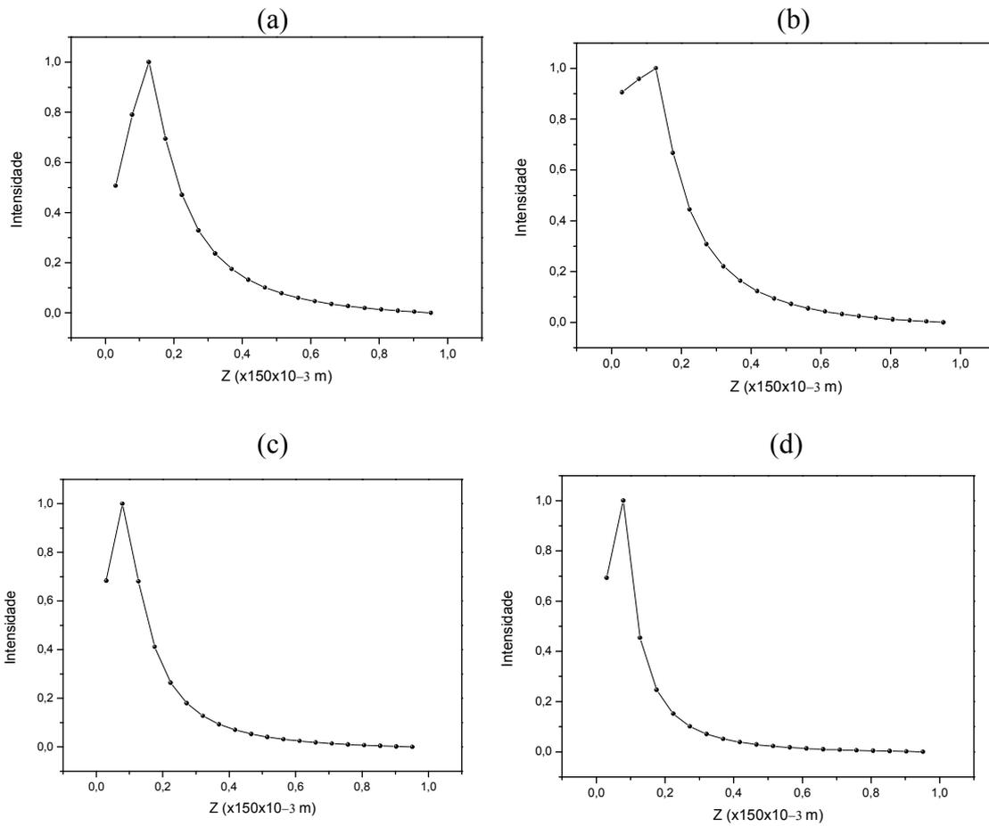
Figura 3.4. Intensidade de pico gerada por coroas circulares de raio externo  $100 \times 10^{-6} m$  e raio interno: (a) zero; (b)  $25 \times 10^{-6} m$ ; (c)  $50 \times 10^{-6} m$  e (d)  $75 \times 10^{-6} m$  em função de  $z$ , medida entre  $z = 4,5 \times 10^{-3} m$  e  $z = 150 \times 10^{-3} m$ .
