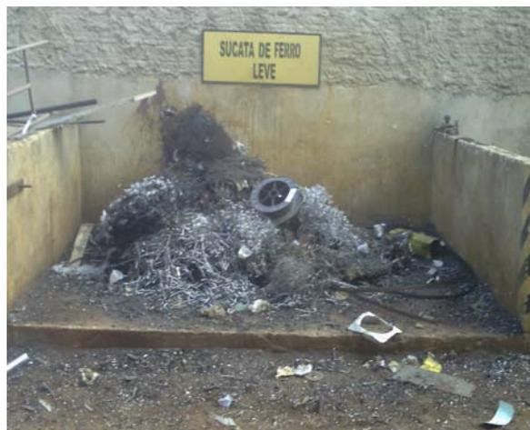
Figura 11 - Limalhas de aço da metalúrgica.
