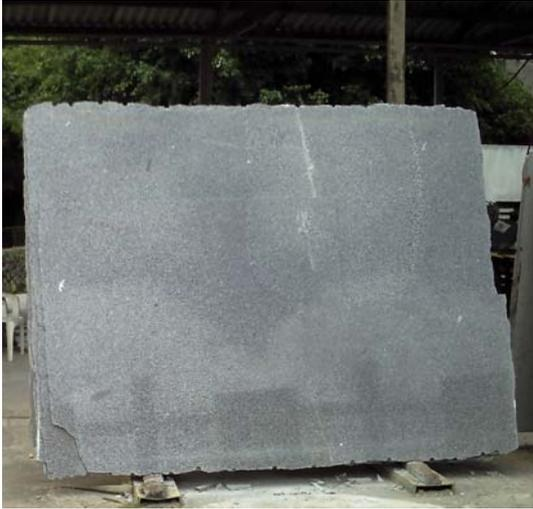
Figura 25 - Chapa polida de granito.
