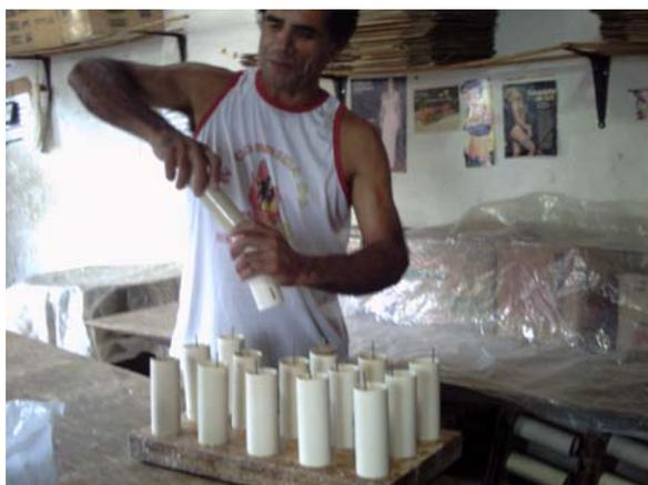
Figura 12 - Fabricação de vela de forma artesanal
