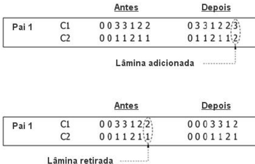
Figura 4.12 – Exemplo da operação de adição e retirada de lâminas.
