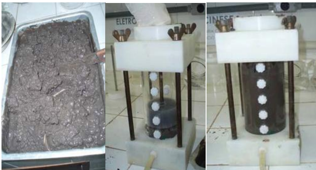
Figura 3.11. Etapas de preparo da amostra na sequência homogeneização, moldagem do corpo de prova, corpo de prova finaliza
