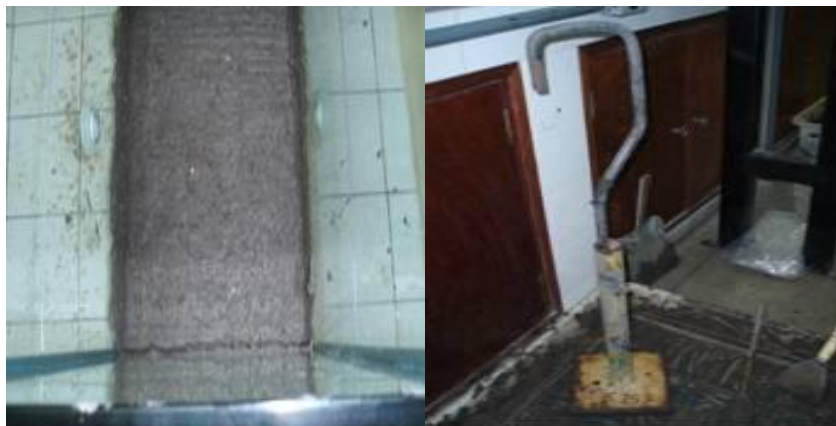
Figura 3.19. Camada de solo no reservatório e soquete de compactação
