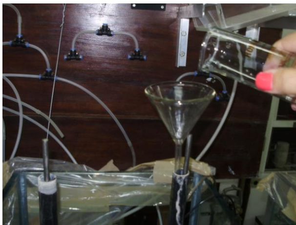
Figura 3.21. Colocação da solução de surfactante nos poços eletrolíticos
