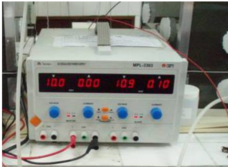
Figura 3.10. Fonte de alimentação do sistema (30 V)
