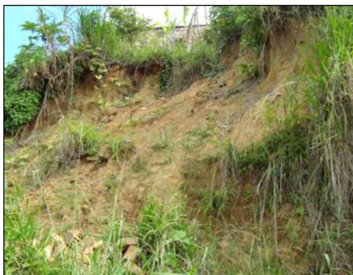
Figura VI.14: Acidente em encosta da Formação Barreiras de Fácies de Leque Aluvial Mediano com Influência Proximal (Alto Dois Carneiros / Jaboatão dos Guararapes).
