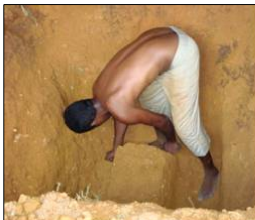
a) Poço exploratório e moldagem do bloco
